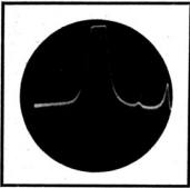
FIG. 14. — La pointe de résonance est aplanie par surcharge de l'amplificateur.
