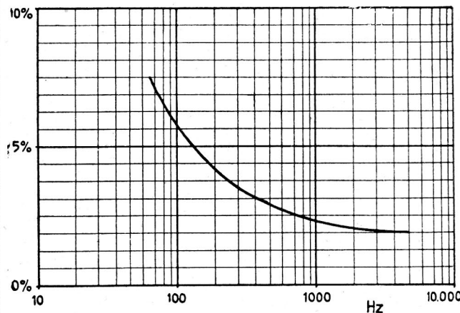
Courbe de la distorsion totale en fonction de la fréquence pour une puissance de sortie de 1 watt. ★
