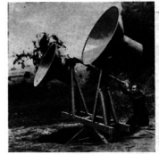
Fig. 3. — Télémètre décimétrique en essais, Septembre 1936.
