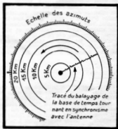
Fig. 3. — Formules de l'image sur l'écran d'une table P.P.I. auquel sont superposés des échelles de distance et d'azimut.
