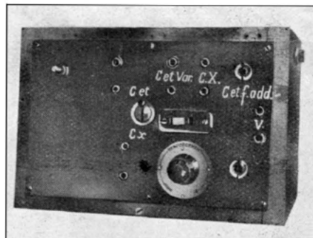
Fig. 2. — Aspect extérieur du capacimètre tel qu'il a été réalisé par l'auteur. Les instruments de mesure et les condensateurs (l'étalon et celui à mesurer) sont à brancher aux fiches prévues à cet effet.
