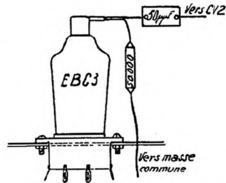
La façon de brancher la résistance de fuite.
