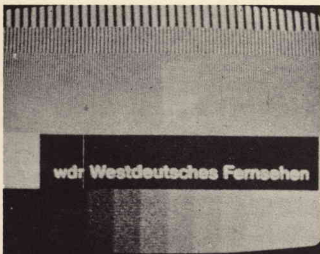
Fig. 4 - Monoscopio elettronico usato dalle stazioni della catena WDR-3.
