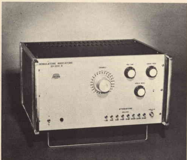
Fig. 2 - Molto semplice ed alla portata di ogni operatore questo pannello di comando del vobulatore-marcatore EP 2011 R così come risulta da questa illustrazione. Pratico ed utile anche in questo strumento l'attenuatore in dB a cellule progressivamente inseribili, disposto accanto al connettore BNC di uscita.
