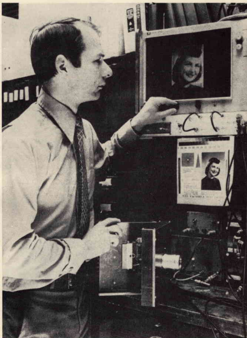
Fig. 1 - Fotografia illustrante la struttura del nuovo tipo di telecamera senza cannone elettronico.
