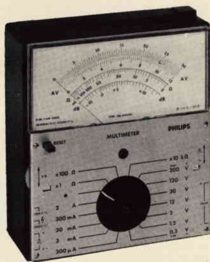
Fig. 7 - Multimetro Philips modello PM 2403 per la misura delle tensioni e delle correnti continue ed alternate, e delle resistenze.
