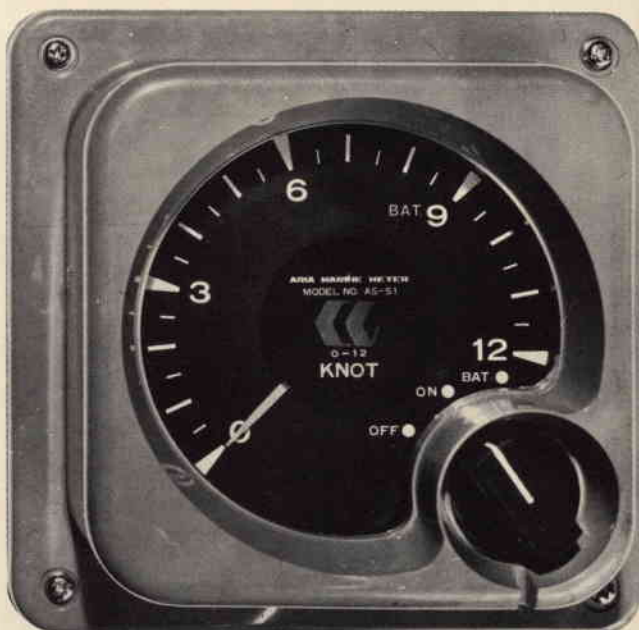
Fig. 5 - Indicatore di velocità elettronico, allo stato solido, per piccole imbarcazioni.
