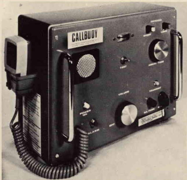
Fig. 2 - Call-Buoy, anch'esso completamente transistorizzato e stagno funzionante su 2182 kHz e con portata di 46 miglia. Questo apparecchio può galleggiare sull'acqua.
