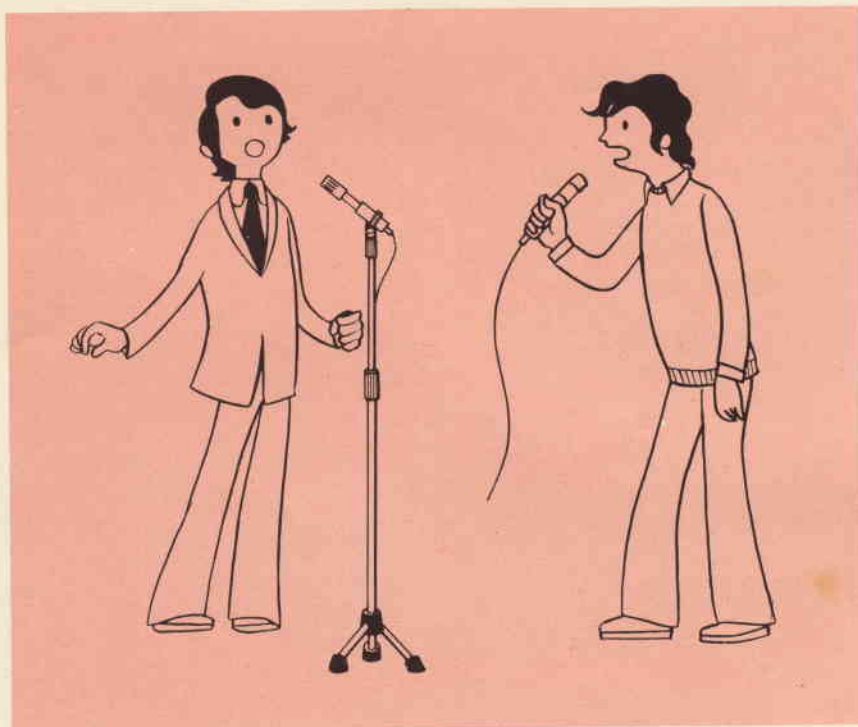
Fig. 13 - Come procedere per la raccolta dei suoni con un microfono con asta di sostegno a sinistra e con un microfono portatile a destra.
