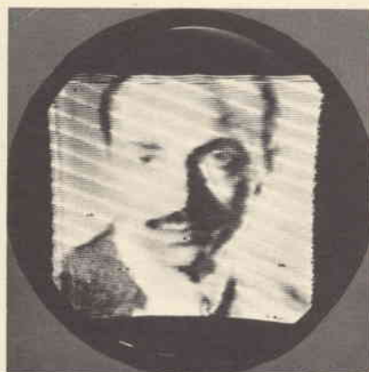
Fig. 7 - In questa immagine trasmessa in un collegamento con il Portogallo, possiamo notare delle linee trasversali, probabilmente dovute ad una cattiva registrazione oppure alla cattiva regolazione, nella telecamera, dei sincronismi od infine alla diversità della frequenza di rete fra il radioamatore che trasmette la immagine e la stazione ricevente.
