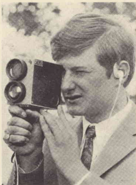
Telefono ottico. Questo apparecchio utilizza come onda portante un raggio infrarosso.
