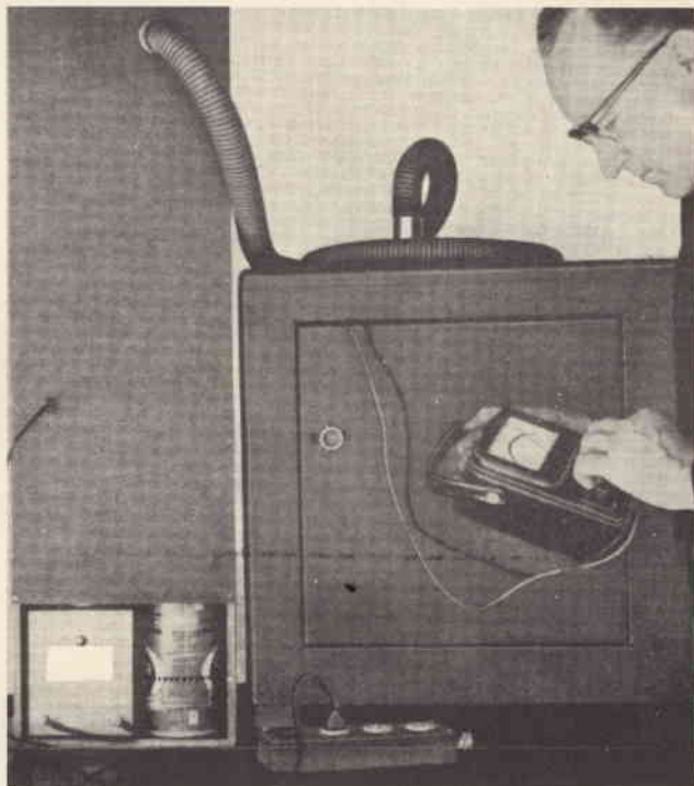
Fig. 9 - Fotografia illustrante il particolare dell'apertura presente in basso sul pannello frontale. Si noti anche il foro di uscita superiore dell'aria depurata, che può essere prelevata mediante un tubo flessibile del tipo normalmente impiegato con gli aspirapolvere. In questa particolare applicazione viene usato anche un secondo mobiletto, che può essere munito di sportello anteriore trasparente, nel quale è possibile eseguire esperimenti particolari, per i quali è necessario che lo ambiente sia esente da sostanze inquinanti.
