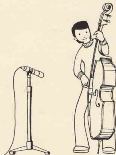
Fig. 21 - Disposizione del microfono per la raccolta dei suoni provenienti da un contrabbasso.
