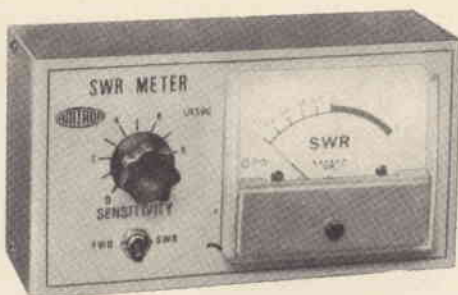
Fig. 4 - Misuratore di ROS (rapporto onde stazionarie) per la gamma di frequenza 3 ÷ 150 MHz regolabile con continuità.
