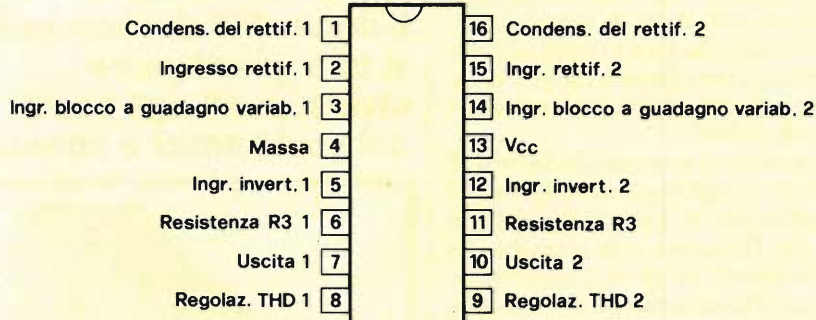
Fig. 7 - Caratteristica di ingresso/uscita dell'unità sustain e zoccolatura dell'integrato NE571.
