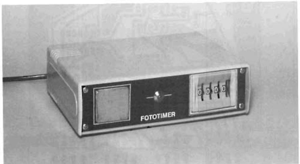
Apparecchio a realizzazione ultimata: sulla destra i contraves per impostare il tempo, al centro il led di segnalazione funzionamento, a sinistra il sensore.
