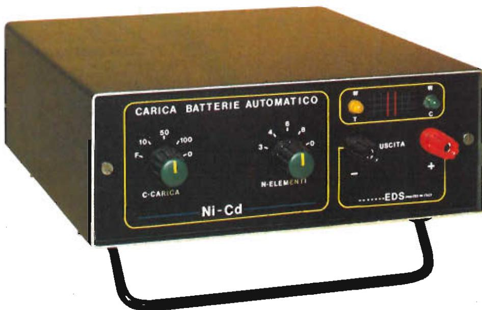
L'apparecchio che vi presentiamo è in grado di rigenerare automaticamente gli elementi al "Ni-Cd" grazie all'impiego di un comparatore a finestra della Siemens siglato TCA965. Lo strumento non solo può essere programmato per il numero di elementi da ricaricare (3-4-6-8 celle) ma si può scegliere tre differenti valori di corrente di carica che vanno da un minimo di 10 mA ad un massimo di 100 mA.
