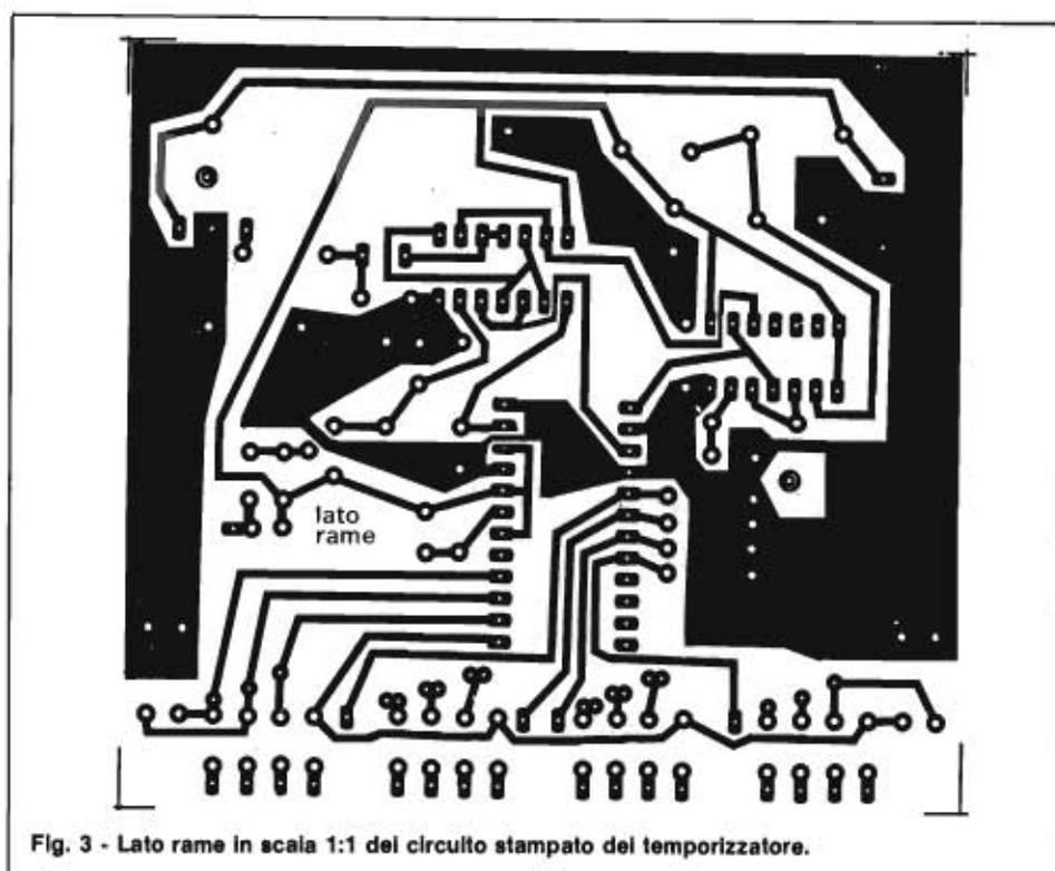
Fig. 3 - Lato rame in scala 1:1 del circuito stampato del temporizzatore.
