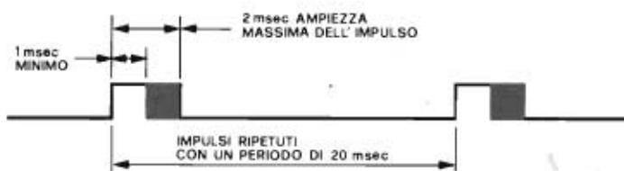
Fig. 2 - Andamento temporale dei segnali di controllo della posizione ad ampiezza di impulso.
