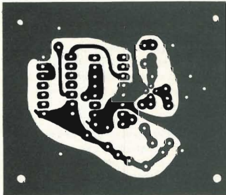
Fig. 3 - Lato rame del "prescaler"
