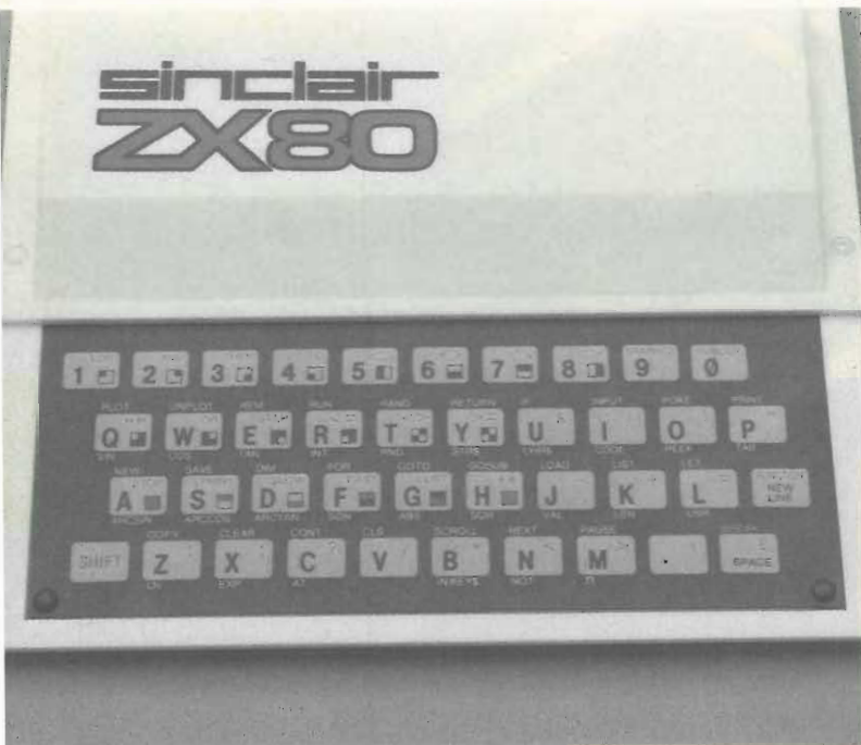
Fig. 5 - La nuova tastiera dello ZX80 dove si possono vedere le nuove funzioni e la particolarità di ogni tasto che arriva ad avere fino a cinque differenti funzioni.
