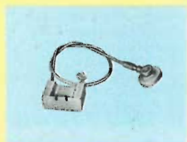
Triplificatore di tensione Mod. BG 1895641093 Tensione d'ingresso: 8,6 kVpp Tensione d'uscita: 25 kV Corrente d'uscita: 1,5 mA Corrente d'uscita fuoco: 300 \mu A MG/4844-00
