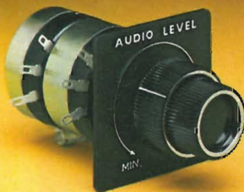
Mod. AT 40 DG Stereo. Impedenza 8 Ω Potenza massima 25 W Manopole coassiali per la regolazione indipendente dei 2 canali RB 0204-08
