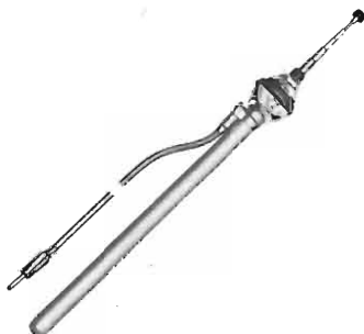
Antenna per autoradio Mod. BSA/28 Fissaggio: su carrozzeria Lunghezza cavo: 1.150 Sezioni: 4 Lunghezza totale: 1.000 Inclinazione: 0°÷43° KT/1800-00
