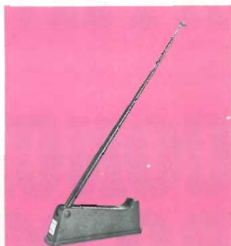
Antenna amplificata per autoradio Mod. BSA/30 Fissaggio: su carrozzeria Sezioni: 8 Lunghezza stilo: 420 Lunghezza cavo: 2.100 Alimentazione: 6-12 V Inclinazione: 0°÷180° KT/2200-00
