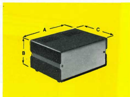
Contentori in alluminio satinato opaco Coperchio e fondo: alluminio verniciato color bronzo Completo di: piedini antivibranti in gomma e fori per aerazione
