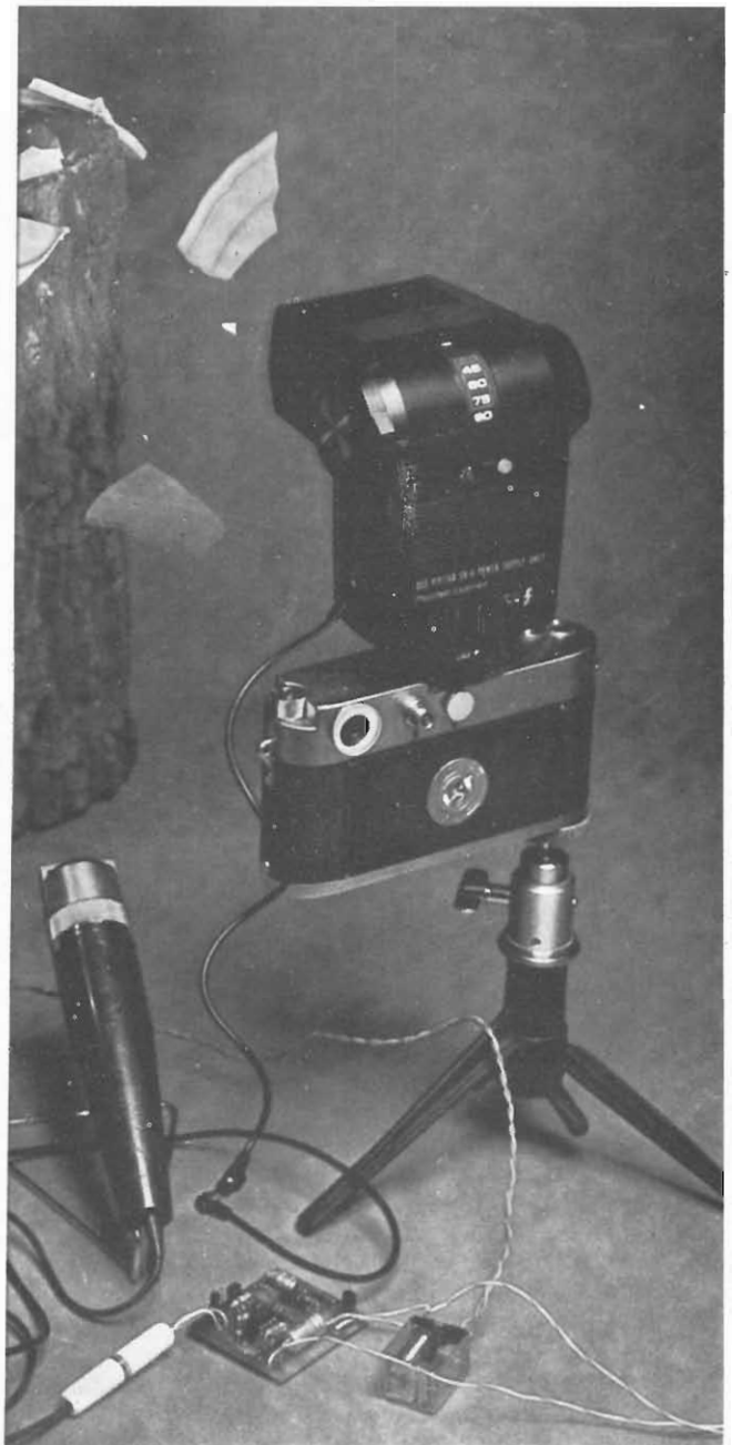
Fig. 6 - Il fonorelais di figura 3 nell'uso (in basso, primo piano). Si nota il relais esterno, a destra. In secondo piano, si scorge il microfono magnetico da impiegarlo, che è del tipo per registratori.
