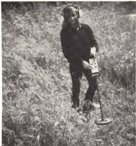
Fig. 3 - Preparazione del C-Scope (taratura per eliminare l'effetto del terreno).
