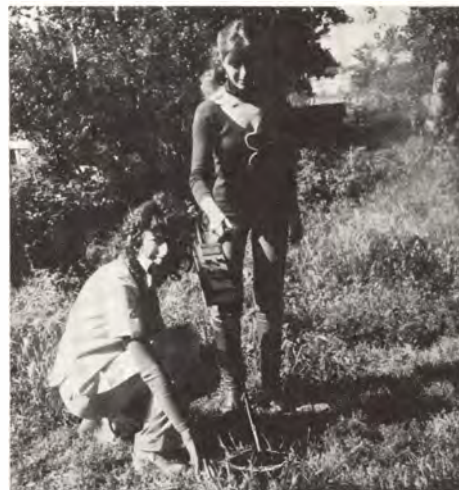
Fig. 5 - Impiego corretto del C-Scope; la "pala della rivettrice" è tenuta a 5 cm dal terreno.
