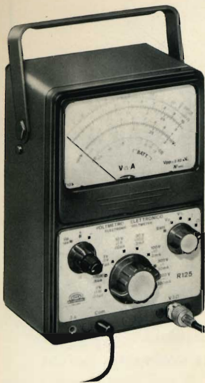
Fig. 2 - Fronte del V.T.V.M. a FET da 10 MΩ di impedenza della UNA. Si noti la chiarezza delle scale, il notevole numero di portate.
