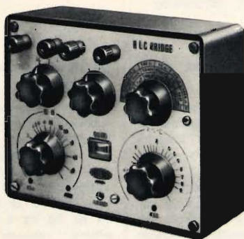
Fig. 6 - Ponte universale di tipo professionale RLC per misure di resistenze, induttanze capacità AMTRON - UK 580 particolarmente indicato per la ricerca di guasti, controllo e calcolo di trasformatori, impedenze e la possibilità di apprezzare la qualità dei condensatori che non è possibile con i normali capacitometri.
