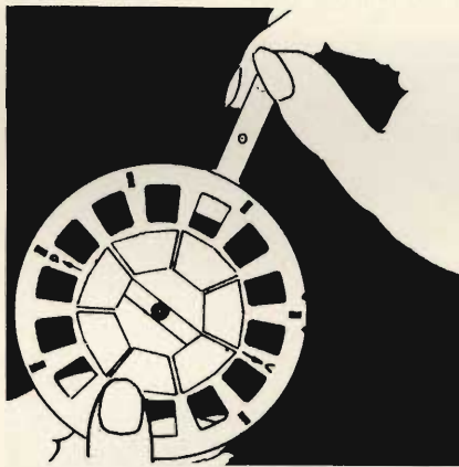
Fig. 8 - Disposizione semplificata delle riprese stereoscopiche su di una pellicola da 35 mm, e su di un disco di osservazione o di proiezione, impiegato nel dispositivo View Master.
