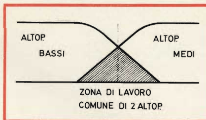
Fig. 11 - La zona tratteggiata è comune all'altoparlante dei bassi e a quello dei medi, pertanto è necessario provocare una attenuazione mediante dei filtri.
