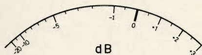
Fig. 6 - Disegno illustrante la struttura della scala del microamperometro, così come deve essere ridisegnata per adattarlo alle indicazioni comprese tra un minimo di -20 ed un massimo di +3 dB.
