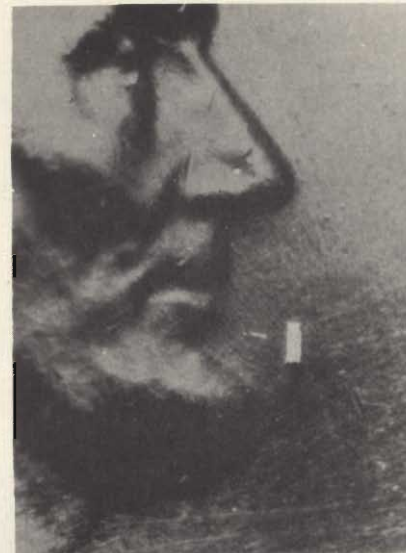
Fig. 12 - Ecco un esempio tipico di laser realizzato con semiconduttori: l'elemento sensibile si trova sulla moneta americana.
