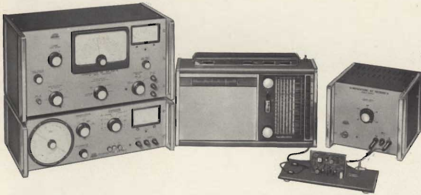
Fig. 4 - In questa foto sono riuniti i componenti fondamentali che hanno permesso la realizzazione e le misure relative. Sulla sinistra si notano i due generatori UNA EP 207 R di alta frequenza sovrapposto a quello di bassa frequenza EM 96 R (di lavoro 10 \text{ Hz} \div 1 \text{ MHz} con onde sinusoidali e quadre). Al centro della foto è disposto il convertitore che è alimentato da un generatore a tensione variabile a scatti di 4,5 - 6 - 9 - 12 V e fornisce la frequenza di conversione ad un ricevitore Satellit Amateur sulla banda dei 14 \div 16 \text{ MHz} . Particolare importanza possono avere per la messa a punto i due generatori qui rappresentati che possono notevolmente facilitare le misure di sensibilità, di immagine e la taratura di scala. Con il generatore EM 86 R della UNA è poi possibile modulare esternamente l'EP 207 R della UNA e ricevere l'effettiva larghezza di banda acustica del ricevitore. Entrambi questi strumenti che sono tra i più robusti e meno costosi tra quelli di costruzione italiana sono in vendita presso la G.B.C.
