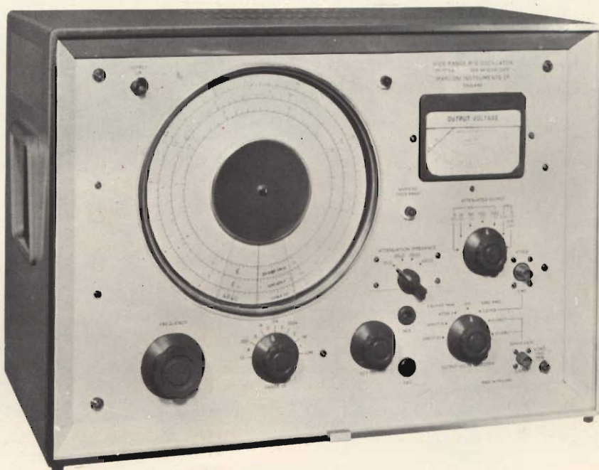
Fig. 1 - Oscillatore professionale RC, Marconi TF 1370 A, per onde sinusoidali da 10 Hz a 10 MHz ed onde quadre sopra i 100 kHz.
