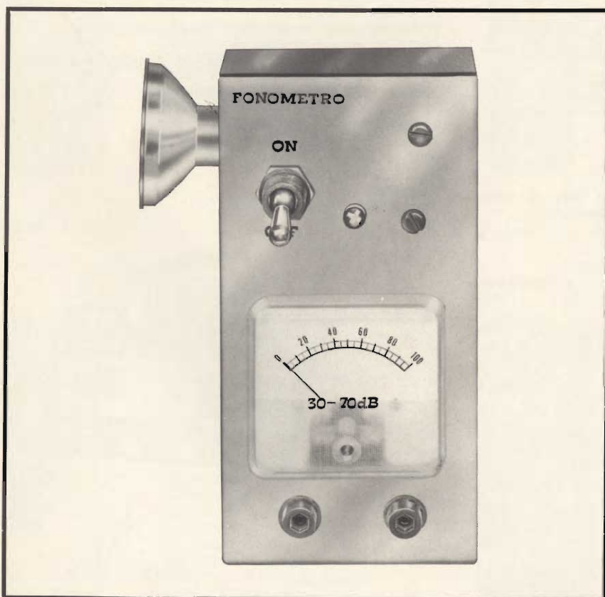
Fig. 4 - Aspetto del fonometro descritto in questo articolo a realizzazione ultimata.
