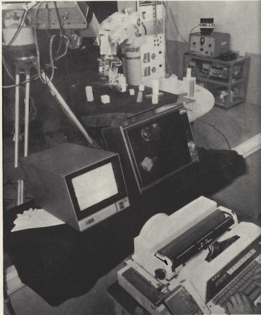
Il robot «intelligente» del MITI dimostra la sua capacità di «pensare» e di «vedere». In alto a sinistra si può vedere il suo «occhio» mentre al centro si vede la sua «mano».
