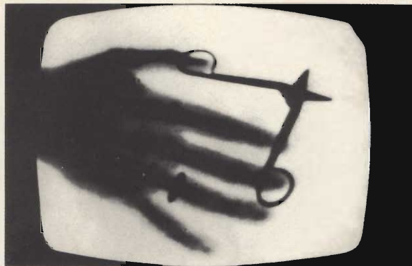
Fig. 2 - Immagine ottenuta con uno schermo fluorescente a raggi X (raggio X a 80 kV - 0,7 mA).
