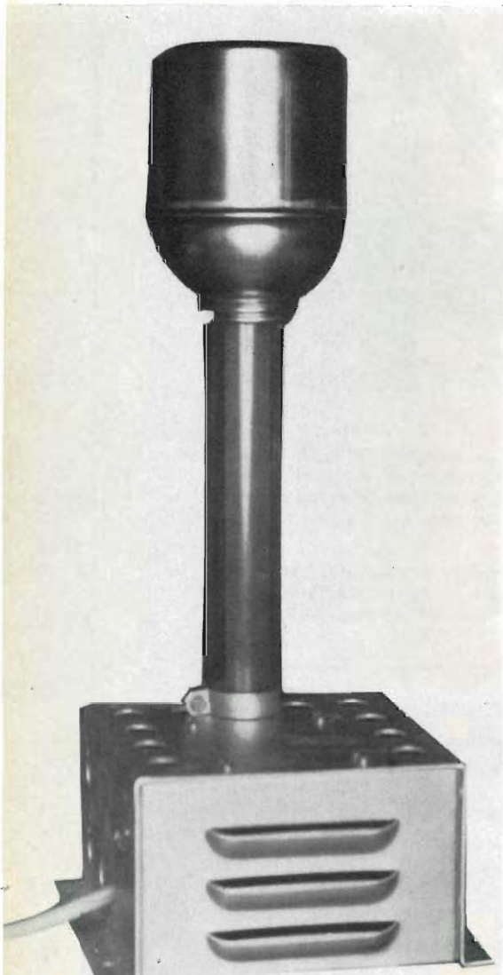
Fig. 1 - Il « minigeneratore » da 50.000 V.
