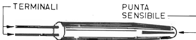
Fig. 1 - Aspetto dell'elemento termosensibile Siemens K17. La sua struttura permette l'applicazione di un tubetto di ottone per prolungarlo, che deve avere una lunghezza di 40-50 millimetri.
