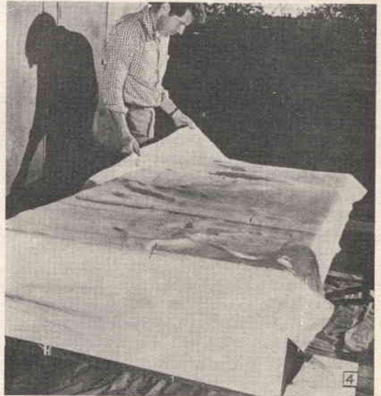
Il rettangolo di ovatta di fibra di vetro, è disteso sul fondo della barca capovolta, dopo avere applicato su questo una mano di vernice protettiva a catalizzazione; le misure debbono essere tali per cui un bordo di almeno 10 cm. di ovatta, ricada tutt'intorno su tutti i lati dello scafo, con esclusione della estremità di prua, dove questo non occorre.
