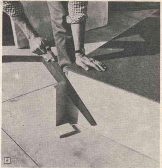
Conviene tagliare a misura le assi delle fiancate, nella parte di poppa, dopo che sia stato messo a dimora il fondo dello scafo e la poppa di esso.
