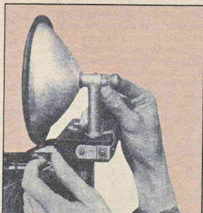
(Foto a sinistra): Foto eseguita con lo stesso riflettore, regolato per la produzione di luce più diffusa (di tipo « flood »). (Foto a destra): La regolazione del riflettore avviene con la semplice manovra della manopolina posteriore, in modo da fare avanzare od arretrare la lampada.
