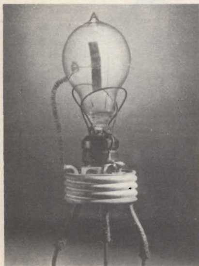
Fig. 6-D - Una fotografia eccezionale: originale del tubo termoionico - diodo - realizzato nel 1904, dal professore A. Fleming.
