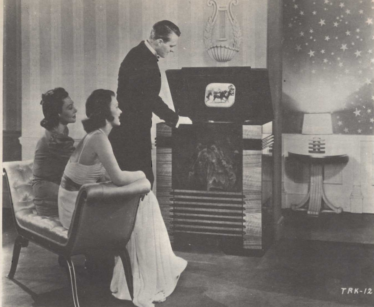
Fig. 17 - Telesivore a visione riflessa del 1939. Le immagini venivano rilette dal cinescopio su di uno specchio fissato sul coperchio del mobile.
