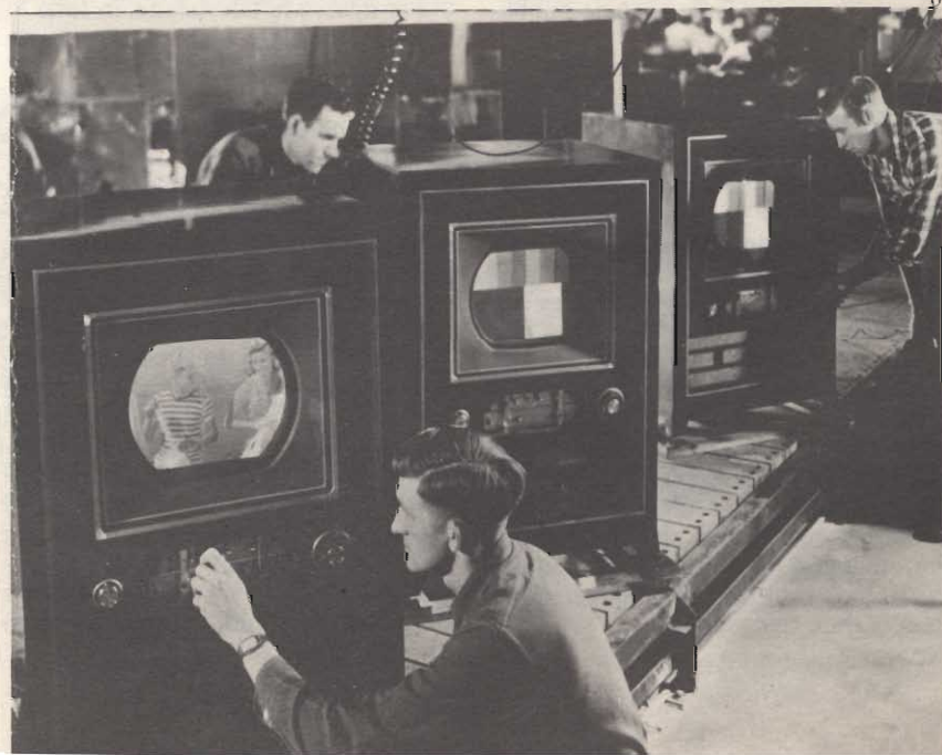
Fig. 6 - Aprile 1950 - Il Sig. Russel R. Law (a sinistra) ed il Dr. H.B. Law mentre ammirano uno dei primi ricevitori TVC completamente elettronico e compatibile con le esistenti ricezioni TV monocromatiche. Il televisore impiegava un solo cinescopio con tre cannoni elettronici ed una terna di sfiori. (vedi testo).
