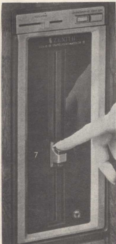
Fig. 16 - Un semplice controllo variabile funziona da selettore di canali in un televisore a colori della Zenith.
