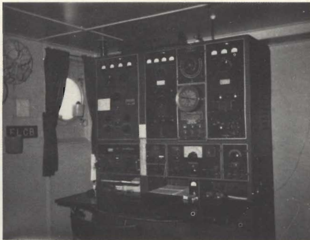
Fig. 5 - Stazione di bordo della Tanker ship «A.N. KEMP», per onde corte e medie, con apparati di emergenza e dispositivo per la trasmissione automatica del segnale di soccorso.
