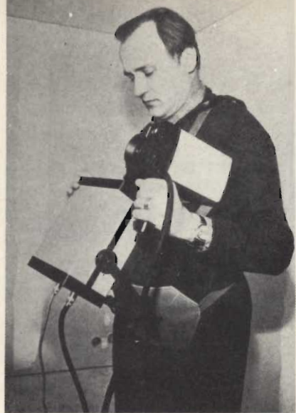
Fig. 3 - Camera a raggi infrarossi, della AGA di tipo portatile, modello Thermovision 750 che consente di controllare rapidamente l'isolamento termico di un edificio.
