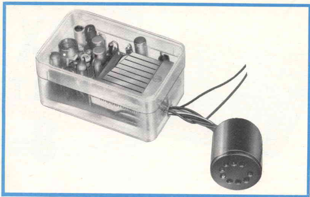
Fig. 1 - Ricevitore RX a 8 canali. Si noti in particolare lo spinotto a 9 piedini per il collegamento con il banco dei relé.
