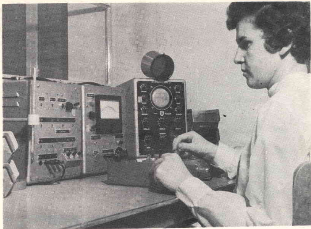
Banco di collaudo per transistor Philips per bassa frequenza.
