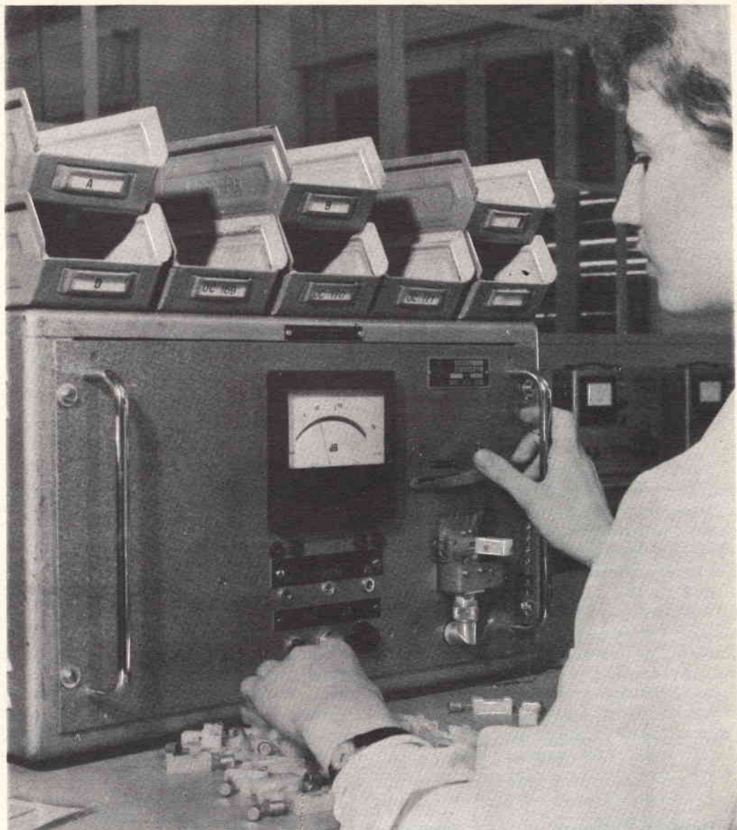
Misura del guadagno di potenza a 100 MHz.
