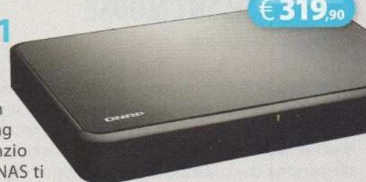
Processore: Intel Celeron 2.41GHz dual-core • Memoria Ram: 1 GB • Numero vani: 2 • Interfacce: 2 LAN Gigabit, 2 USB 2.0, 2 USB 3.0, HDMI • Dimensioni: 41.3 x 302 x 220 mm
