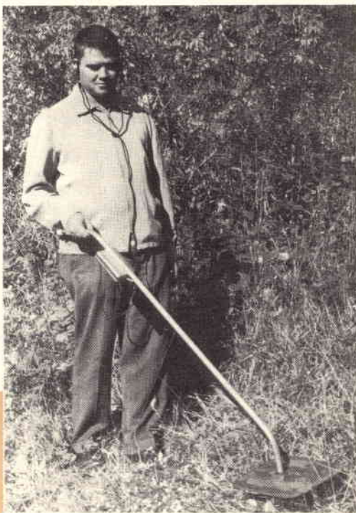
Fig. 1 - Il rivelatore di metalli prodotto dalla Electronic Applications Co. impiega due oscillatori ed un rivelatore-amplificatore. I metalli alterano l'induttanza della bobina di rilevamento (ved. foto) mutando la frequenza delle oscillazioni di Q1 e quindi il tono della nota udita.
