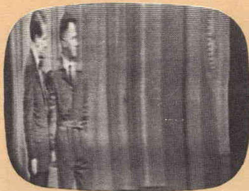
Restringimento orizzontale, spesso dovuto ad esaurimento dei tubi orizzontali o della raddrizzatrice AT. Per eliminare l'inconveniente regolate il controllo di larghezza; sostituite la valvola finale orizzontale e la raddrizzatrice AT.
