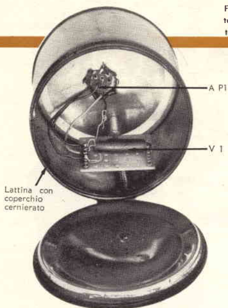
Fig. 2 - La custodia dello strumento contiene un semplice amplificatore in corrente continua con i relativi controlli. Un cavo a tre conduttori (che non compare nella figura) ha il compito d'inviare nell'amplificatore il segnale proveniente dalla camera di ionizzazione.
