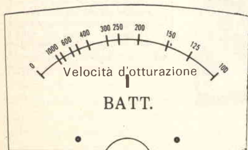
Fig. 3 - Ritagliate o copiate questa scala e sostituitela a quella originale dello strumento.
