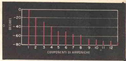
Fig. 3 - Distribuzione ed intensità relative dei prodotti di distorsione armonica introdotti da Olson nelle sue prove d'ascolto. Relativamente alla fondamentale, qui è indicato un livello di distorsione armonica totale del 12%.
