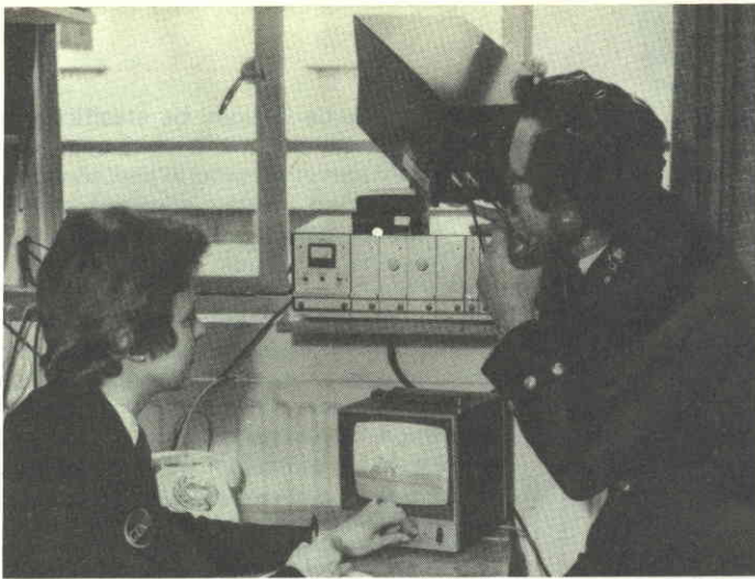
LeeLinks è la denominazione data a questo sistema della Leever-Rich Equipment Ltd., il quale comunica per mezzo di radiazione infrarossa modulata anziché con comuni radioonde.
