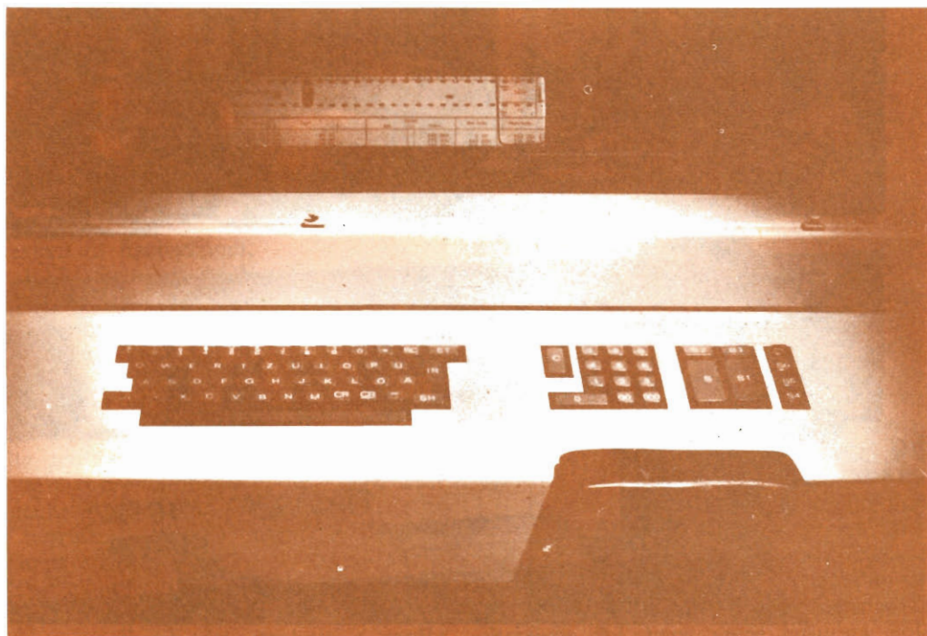
La tastiera dell'elaboratore P 350 è composta da una tastiera convenzionale da macchina da scrivere per i dati alfanumerici e da una tastiera numerica internazionale a 10 tasti per i dati numerici.
