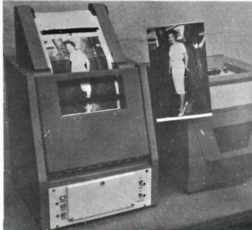
In apparecchi delle dimensioni di una comune scatola, sistemi fax normali registrano una fotografia inserita a destra e riprodotta a sinistra.
