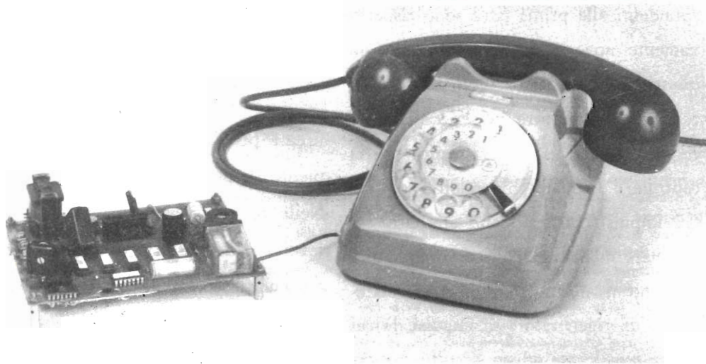
Fig. 1 - Dispositivo a microcircuiti progettato dalla SGS per abilitare o disabilitare gli apparecchi telefonici privati alle chiamate in teleselezione, escludendo ogni possibilità di disturbi.
