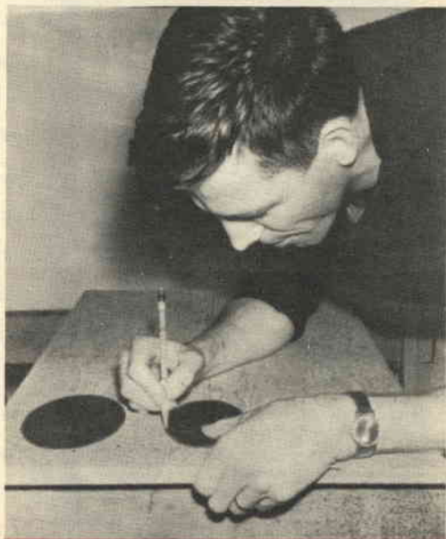
Fig. 4 - I modelli di cartone pesante permettono di disegnare agevolmente le aperture da praticare nel pannello frontale. A seconda delle dimensioni di ogni altoparlante utilizzato, è necessario fabbricarsi un modello appropriato.
