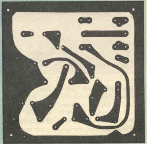
Fig. 5 - Disegno dei due circuiti stampati, di identiche dimensioni, visti dal lato delle piste di rame. A sinistra è rappresentato il circuito del preamplificatore, e sopra quello del controllo dei toni. Per la versione stereo sono necessari quattro circuiti e cioè due per ogni canale.
