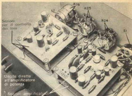
Fig. 7 - Le sezioni amplificatrici e di controllo dei toni si possono montare una sull'altra. Notate i controlli doppi usati per un impianto stereo.
