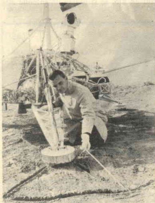
Fig. 4 - I dinamometri elettronici hanno reso possibile il controllo e la trasmissione a terra, via radio, di ogni informazione relativa alla discesa "dolce" sulla Luna del "Surveyor 1".
