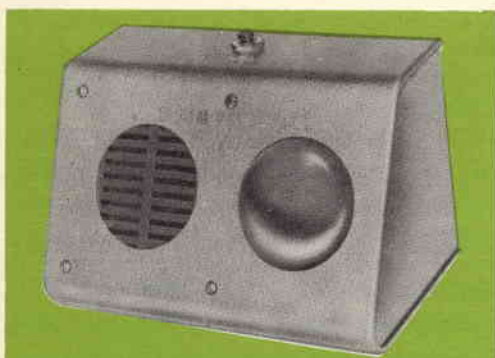
Il prototipo del sistema d'allarme è montato in un mobiletto con pannello frontale inclinato sul quale è visibile, a sinistra, il foro per l'altoparlante. Si può usare però una scatola di forma diversa.
