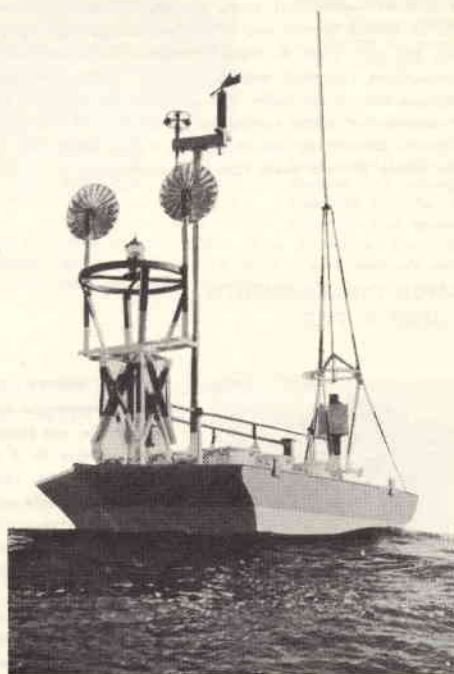
Una linea di ancore speciali, fatte in gran parte di boe di nailon, tiene fermo il vascello sopra più di cinquemila metri d'acqua.
