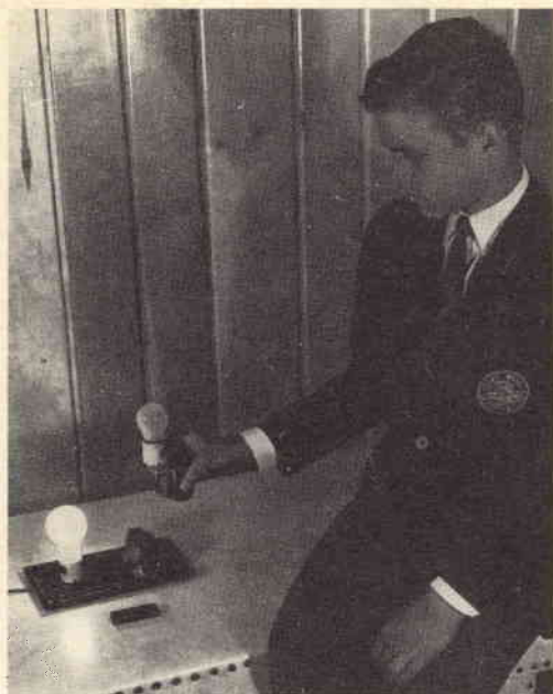
Fig. 1 - L'operatore toglie il giogo a forma di I dall'induttanza L1, riducendo l'induttanza della bobina e facendo di conseguenza brillare vivamente la lampada da 60 W (I1) collegata in serie.
