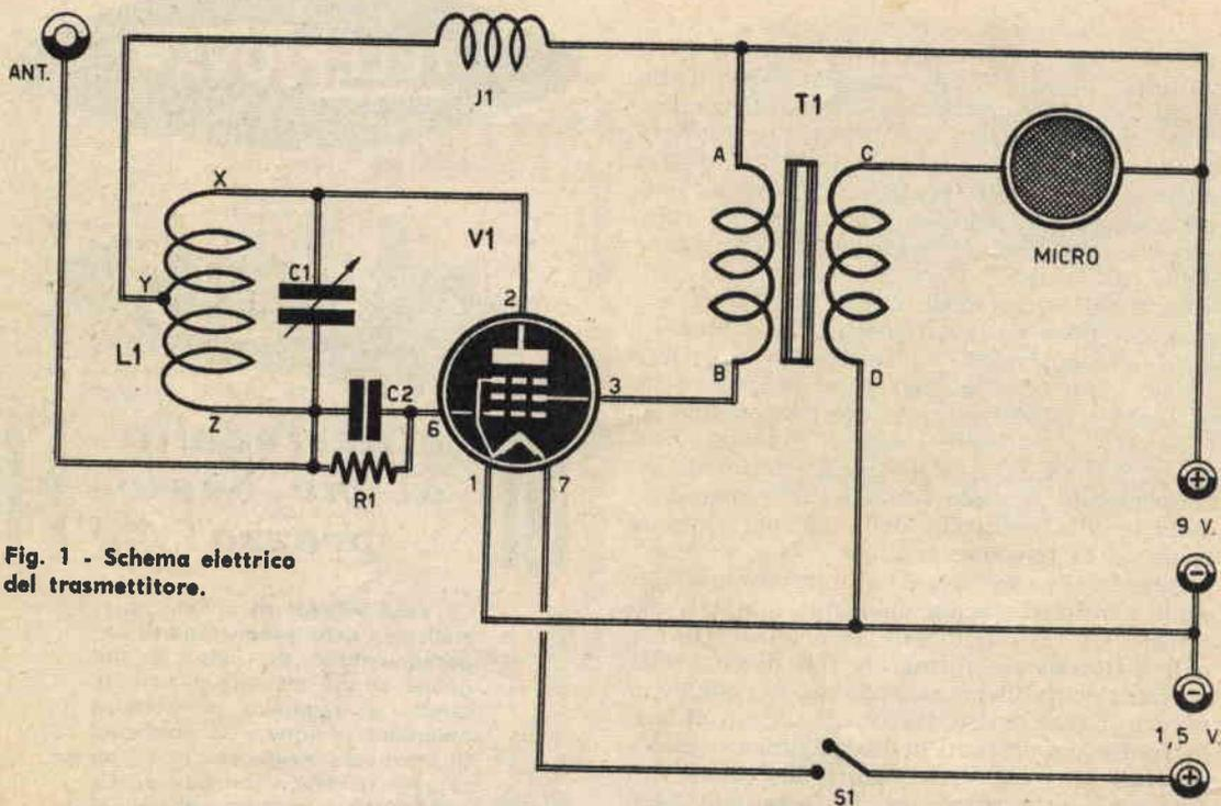
Fig. 1 - Schema elettrico del trasmettitore.
