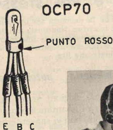
Fig. 3 - Il terminale di collettore del fototransistore OCP70 trovasi in corrispondenza di un puntino rosso.
