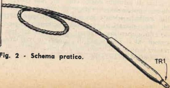
Per il fototransistore TR1 è stato fatto impiego del transistor OCP 70.
