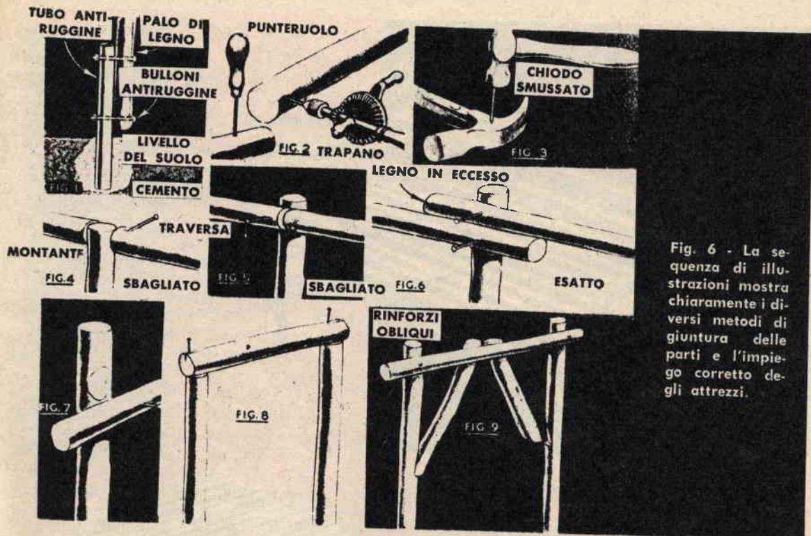
Fig. 6 - La sequenza di illustrazioni mostra chiaramente i diversi metodi di giuntura delle parti e l'impiego corretto degli attrezzi.
