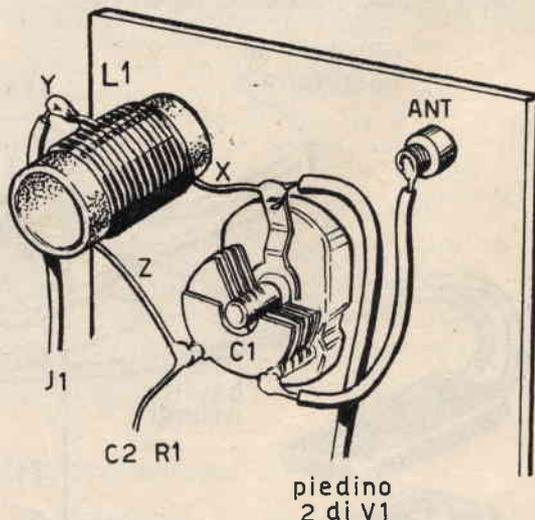
Fig. 3 - Per aumentare la portata del trasmettitore occorre apportare alcuni accorgimenti tecnici al circuito preferendo l'impiego delle onde corte. Lo schema di figura costituisce appunto la variante per la trasmissione sulle onde corte.
