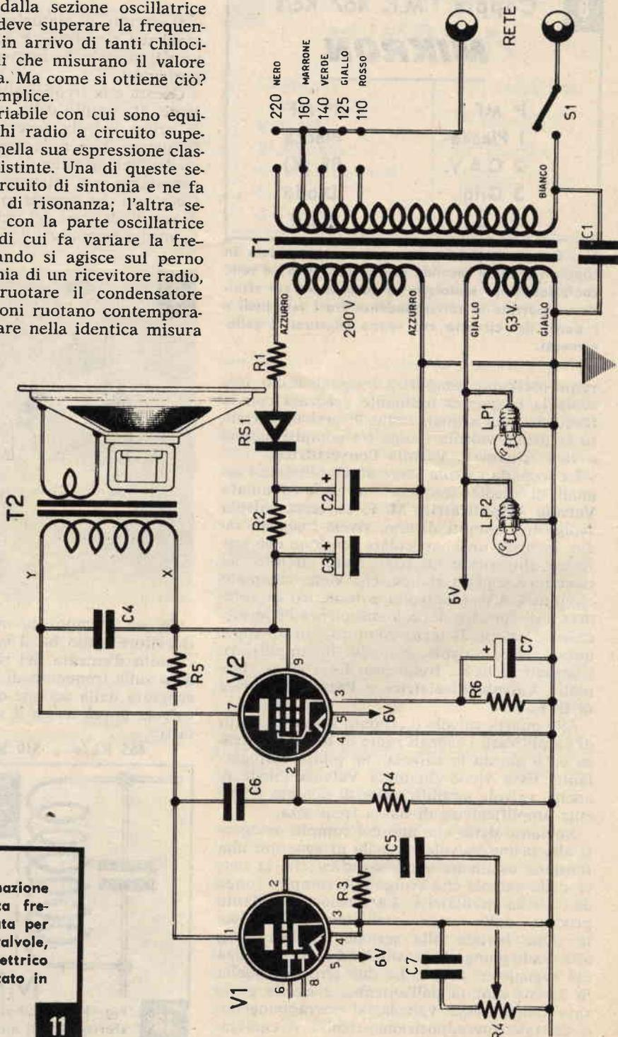
Fig. 11 - La eliminazione della parte ad alta frequenza, già utilizzata per il ricevitore a due valvole, riduce lo schema elettrico a quello rappresentato in figura.
