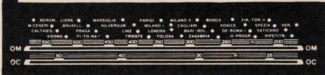
cli o megacicli; la numerazione della scala espressa in lunghezze d'onda dei segnali radio delle stazioni trasmettenti risulta espressa in metri.
