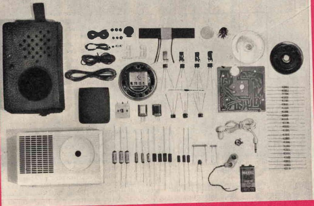
LA SCATOLA DI MONTAGGIO per ricevitore a 7 trans. supereterodina, che si monta col solo aiuto di un saldatore.
