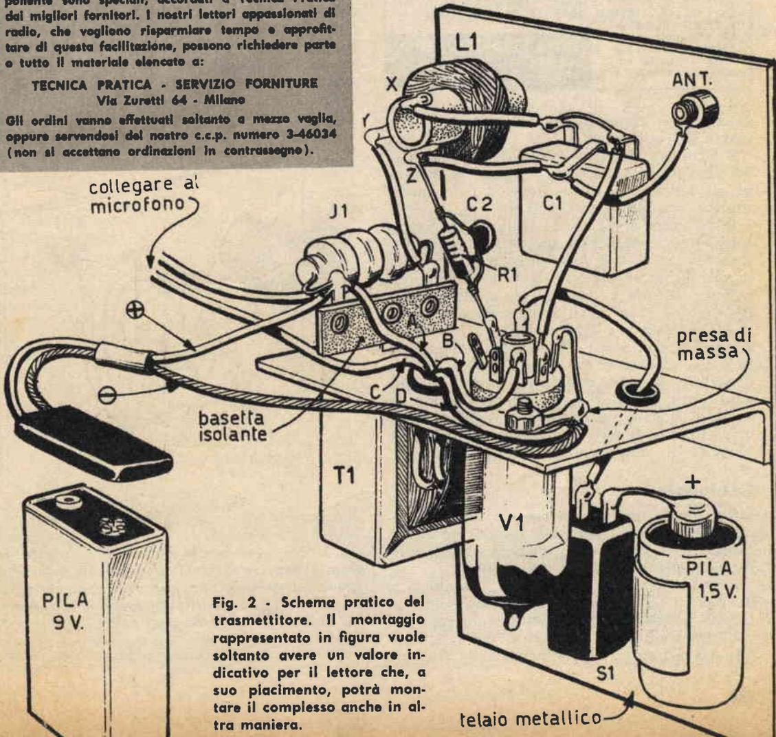
Fig. 2 - Schema pratico del trasmettitore. Il montaggio rappresentato in figura vuole soltanto avere un valore indicativo per il lettore che, a suo piacimento, potrà montare il complesso anche in altra maniera.
