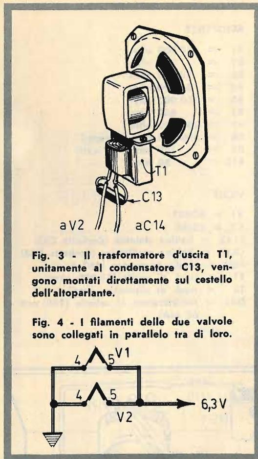
Fig. 3 - Il trasformatore d'uscita T1, unitamente al condensatore C13, vengono montati direttamente sul cestello dell'altoparlante.
