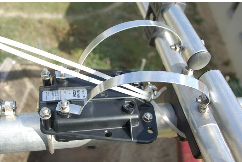
Le balun de l'antenne directive HF en cours de montage ci-dessous.
