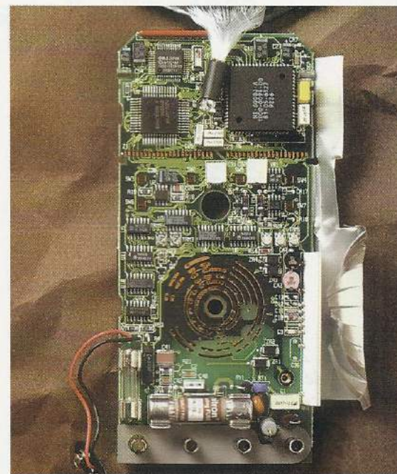
Le 2030 à nu, le carénage interne en plastique transparent thermoformé a été ôté. On distingue l'ensemble de l'électronique où la technologie CMS se taille la plus grosse part.
