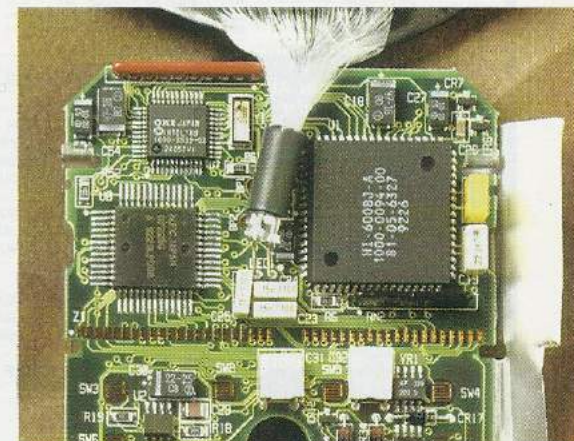
Gros plan sur les circuits de gestion : microcontrôleur et circuits d'affichage, placés sous l'afficheur ôté.
