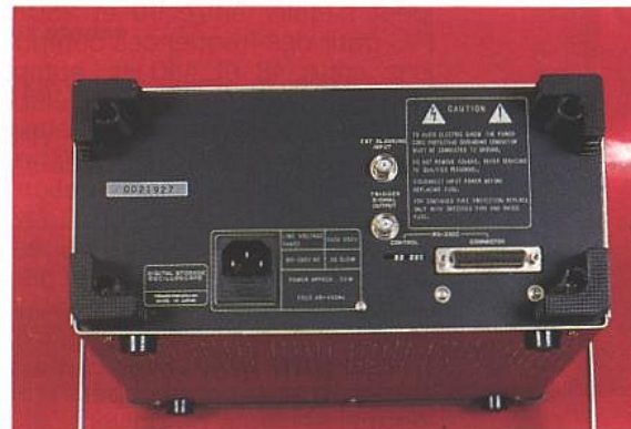
La face arrière avec le connecteur DB 25 RS 232 C, le jeu de switches de configuration. On notera aussi les prises d'entrée axe Z et de sortie trigger (BNC).
