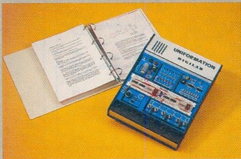
Le Digilab, un ensemble d'expérimentation qui vous fera découvrir les réalités professionnelles de l'électronique digitale (appelée aussi logique, ou numérique).
