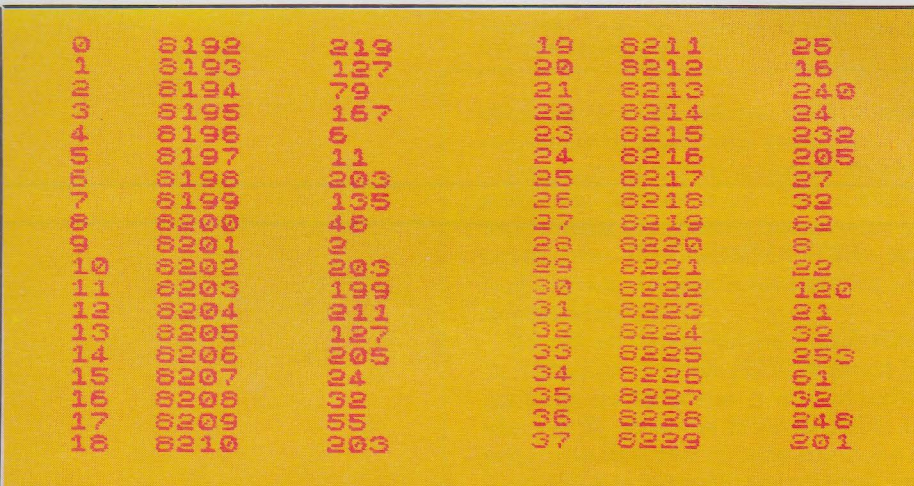
Figure 22 - Le programme d'émission permanente pour la carte microprocesseur. Les états des 8 entrées sont émis en série sans relâche. La réception peut se faire sur une seconde carte, ou sur un ZX 81 en mode FAST, à condition d'adapter numéro de port et réglage de vitesse.
