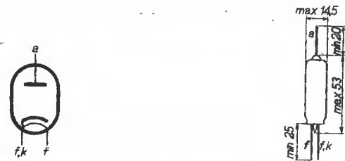
EY 51. - Connessioni allo zoccolo (visto di sotto) e dimensioni di ingombro.
