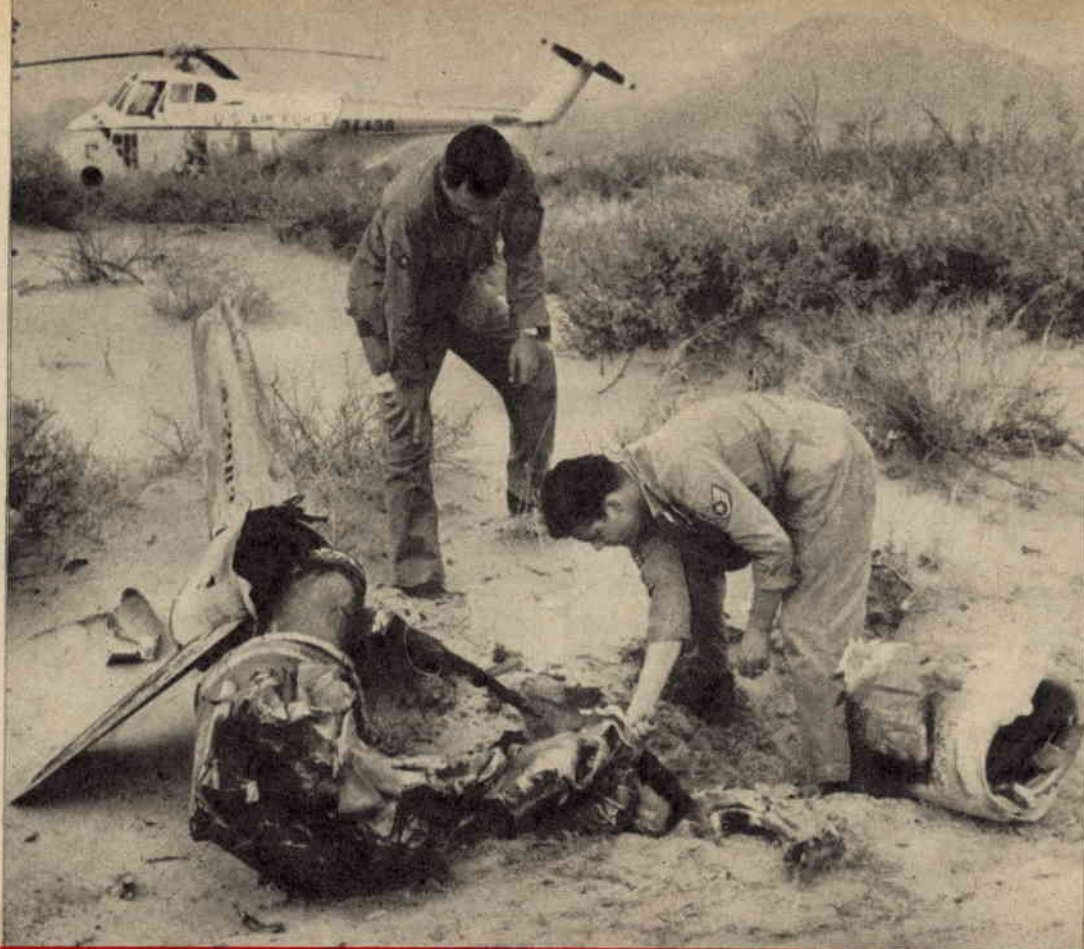
Giunti in elicottero sul posto, questi tecnici esaminano i resti di un razzo precipitato da una altezza di 130 chilometri. Sulla testa del razzo, per poter salvaguardare nella caduta i delicati strumenti in essa contenuti era stato sistemato un paracadute. Purtroppo la testa del missile, troppo pesante per il paracadute, si è irrimediabilmente schiantata a terra.
