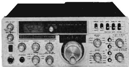
FT 107 M: ricetrasmittitore sulle decametriche da 160 a 10 m. più WWV/JJY e due bande optional SSB-CW-AM-FSK. 240 W. (in SSB) - memoria DMS.
