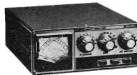
CNW 418: accordatore d'antenna 20/200 Watt DAIWA.
