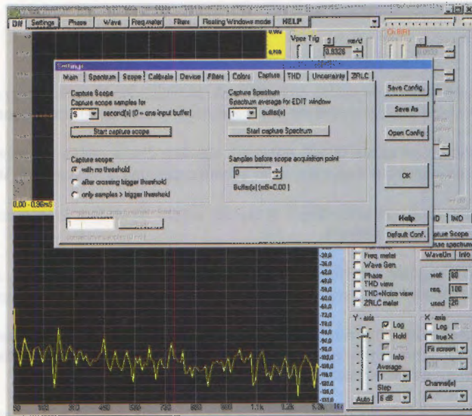
Fig.25 In questa finestra sono presenti due sezioni principali e cioè il Capture Scope a sinistra e il Capture Spectrum a destra. Noi utilizzeremo la sezione Capture Scope che è quella che si riferisce all'oscilloscopio.
