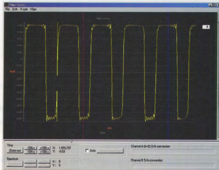
Fig.35 Come potete osservare il segnale prodotto dall'oscillatore è costituito da una serie di onde rettangolari . Ora posizionate il cursore del mouse in modo che la linea verticale che attraversa lo schermo vada a posizionarsi esattamente sul fronte di salita del secondo picco , come indicato in figura. Osservate in basso a sinistra la dicitura che compare a fianco del tasto +15%x :
