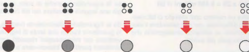
Fig.4 Per spiegarvi come con due soli livelli logici 1-0 si ottengano tutte le tonalità dal Nero al Bianco, abbiamo utilizzato 4 soli punti.
