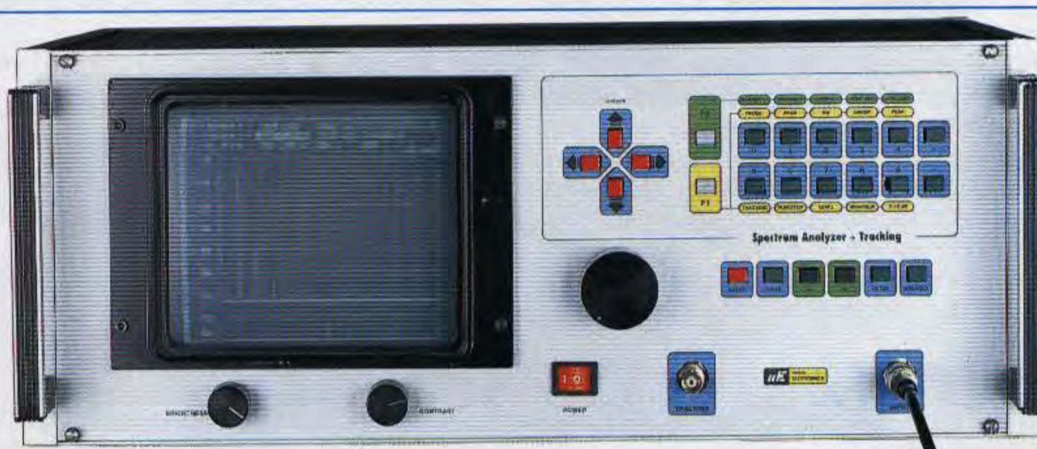
Fig.5 Sul pannello frontale del mobile trovate tutti i pulsanti corrispondenti alle diverse funzioni, la manopola dell'encoder per spostare la traccia o i cursori dei Marker e le due manopole per regolare la luminosità ed il contrasto del monitor. Il segnale RF, che non dovrà mai superare gli 0,2 watt, andrà applicato sul BNC posto in basso sulla destra.
