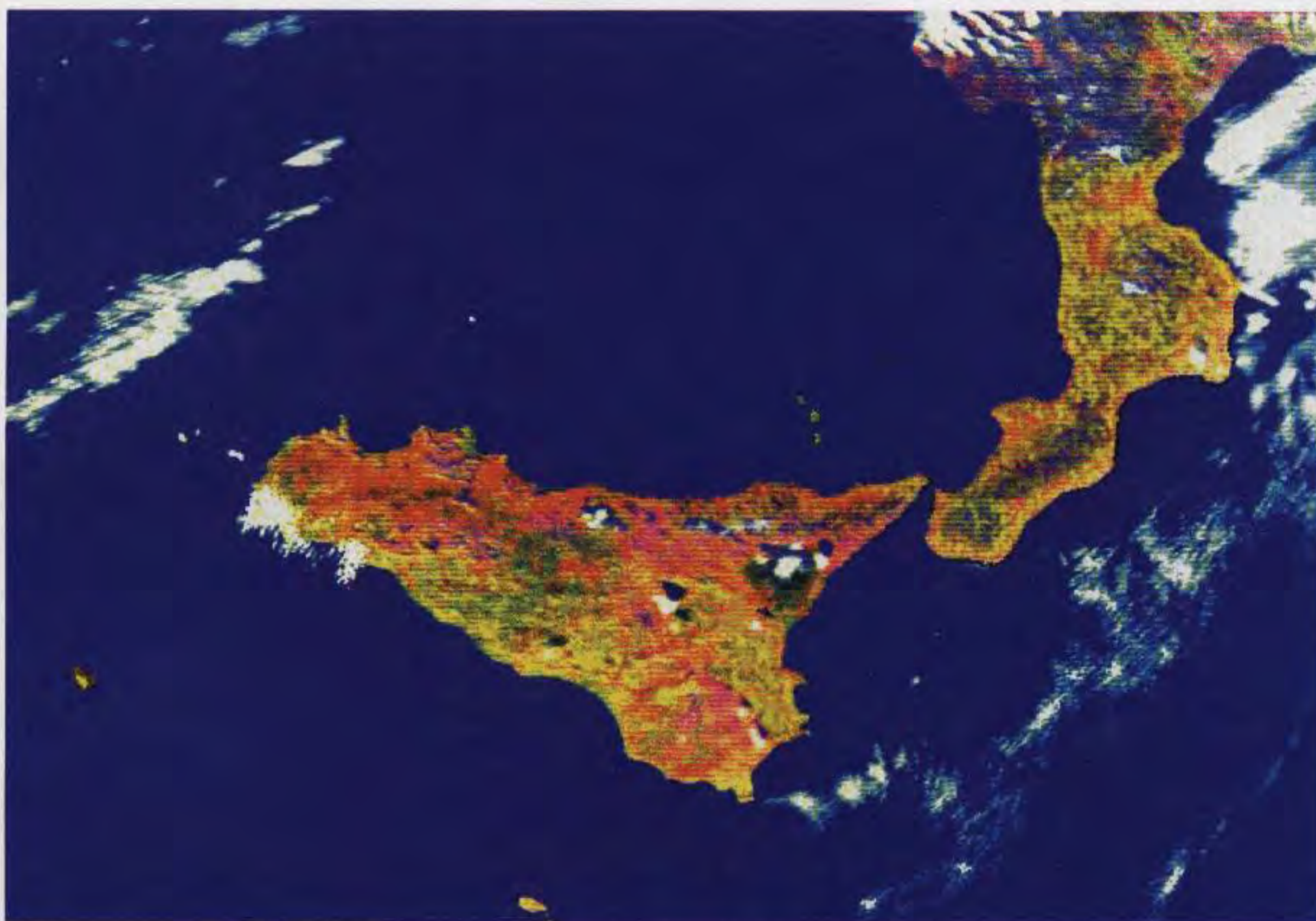
Fig.9 Seguendo l'orbita del satellite con una parabola del diametro di 1 metro circa, è possibile captare le immagini, partendo dalla Scandinavia fino ad arrivare alla Libia e all'Egitto. In questa foto della Sicilia sono ben visibili le isole Eolie e, in basso, Malta.
