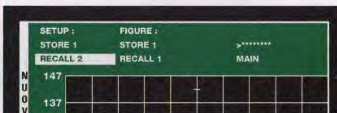
Fig.33 Per vedere i dati in Store 2 , portate il cursore su Recall 1 e pigiate il tasto + affinché appaia Recall 2 , poi pigiate Enter .
