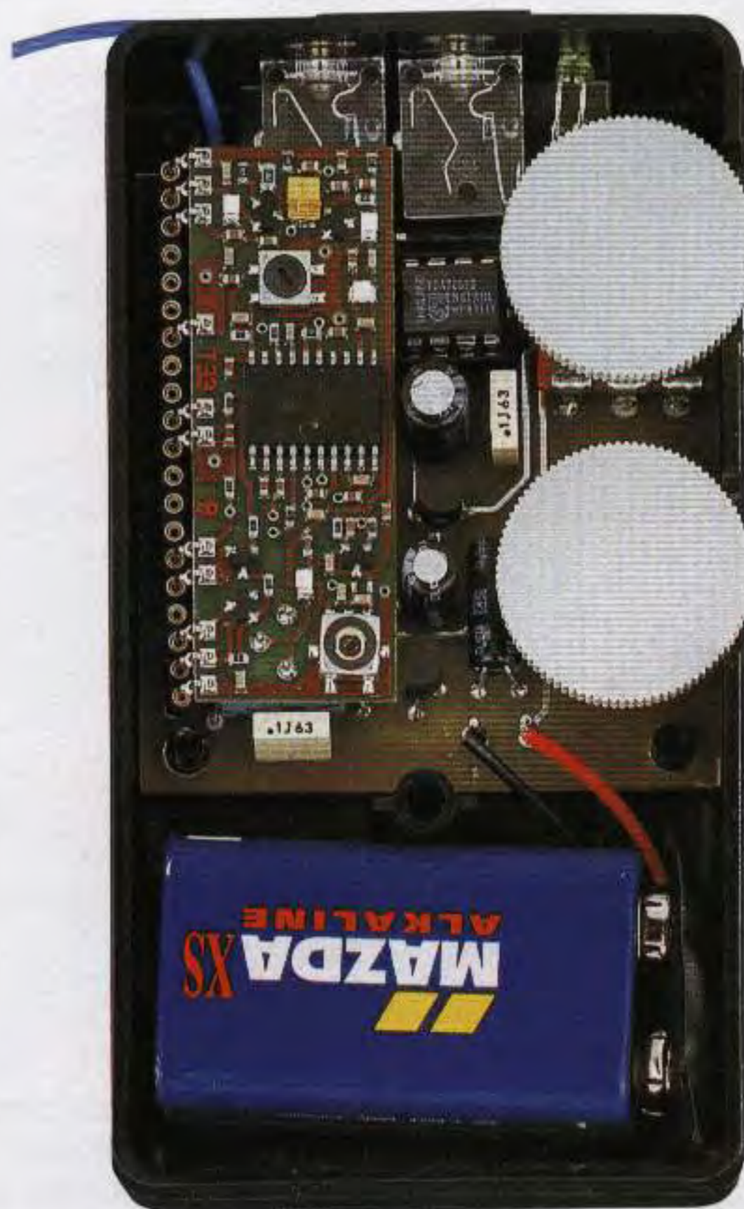
Fig.15 (Foto in alto) Prima di inserire il circuito stampato nel mobile dovete forare quest'ultimo. Nella fig.17 è riprodotto il disegno schematico con tutte le quote della foratura.
