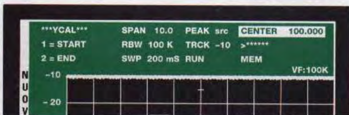
Fig.42 Quando apparirà questo menu, se volete effettuare la calibrazione del Tracking pigiate il tasto numerico 1.
