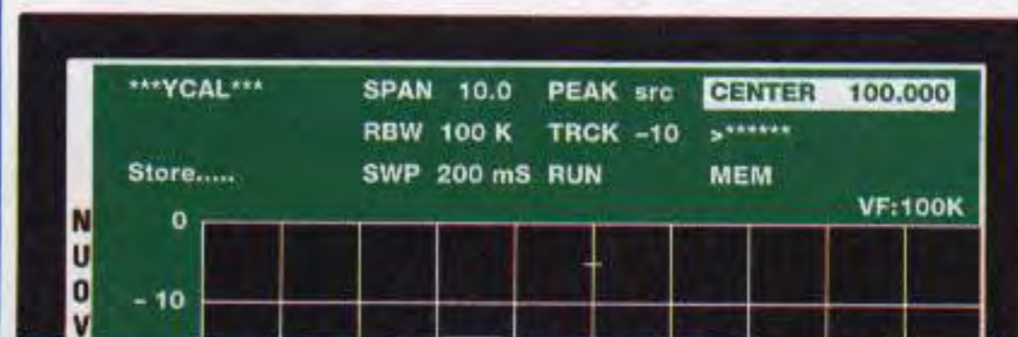
Fig.44 Quando al posto di Wait apparirà, per pochi secondi, la scritta Store saprete che la calibrazione è stata completata.
