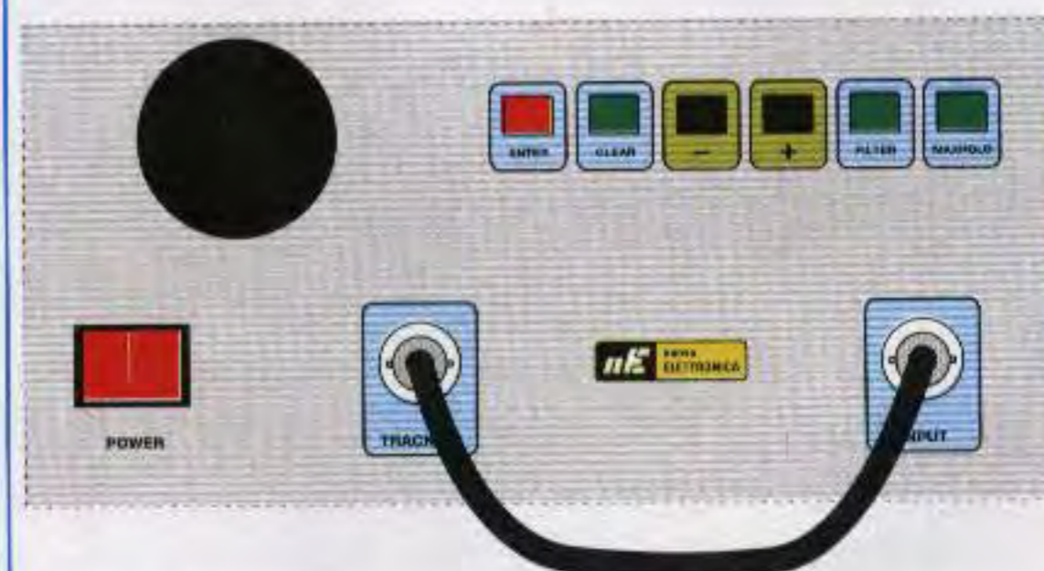
Fig. 38 Per controllare se il Tracking risulta calibrato collegate la sua uscita al BNC d'ingresso tramite un cavetto coassiale.
