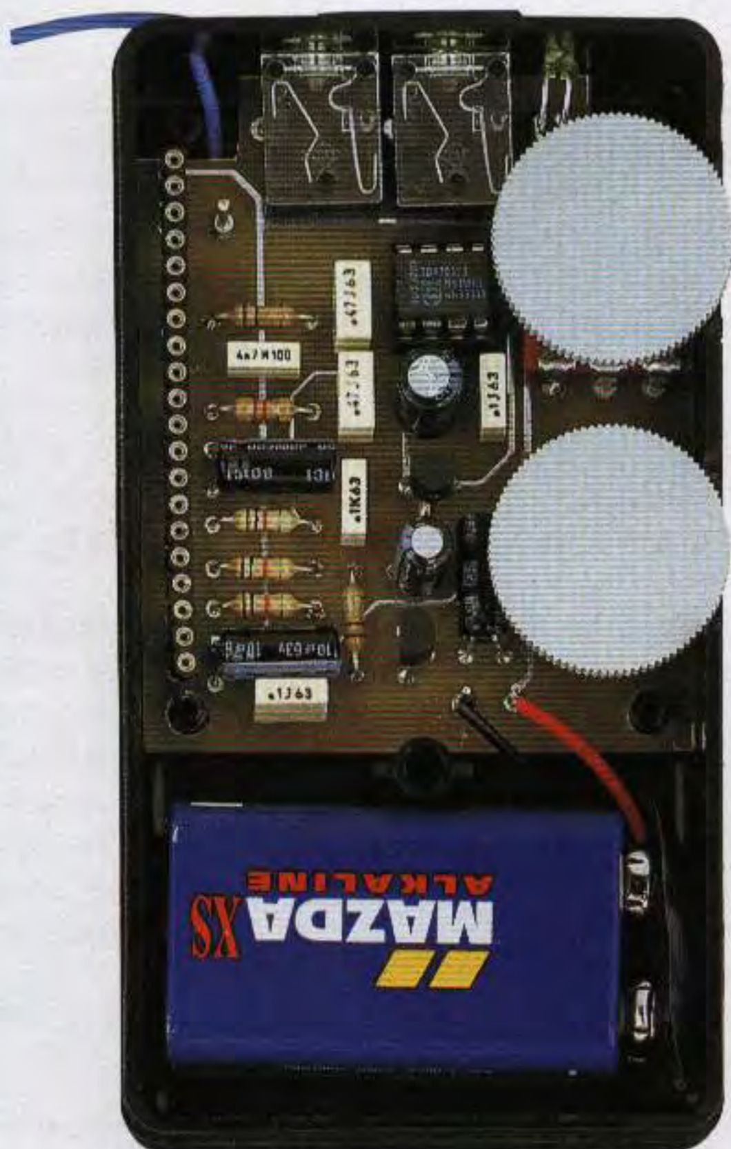
Fig.15 (Foto in alto) Prima di inserire il circuito stampato nel mobile dovete forare quest'ultimo. Nella fig.17 è riprodotto il disegno schematico con tutte le quote della foratura.
