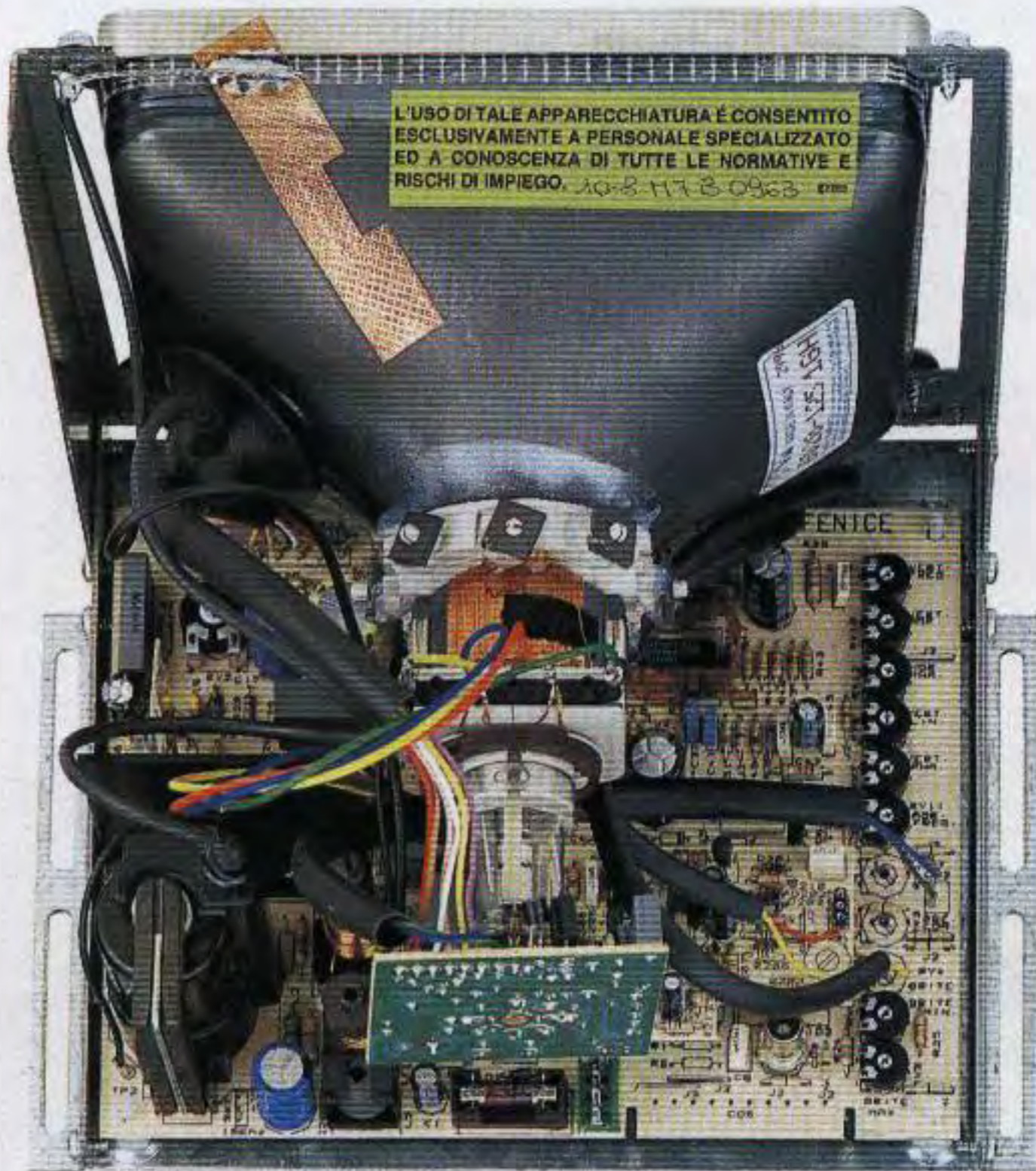
Fig.9 Foto del monitor da 8" con fosfori verdi che vi forniamo già montato e tarato. Per farlo funzionare occorre solo alimentarlo con una tensione di 12 volt.
