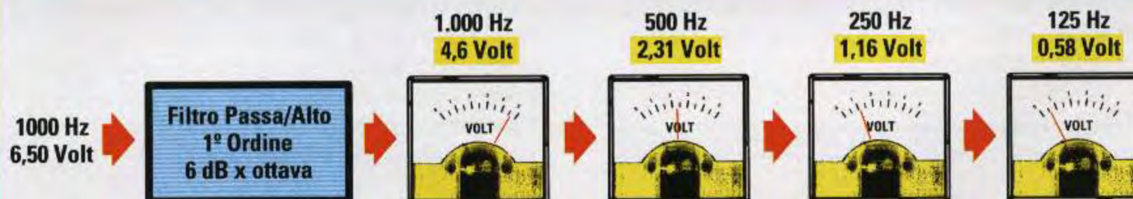
Fig.204 Se sull'ingresso di un filtro passa-alto da 6 dB x ottava calcolato per i 1.000 Hz applichiamo un segnale di 6,5 volt, la frequenza di 1.000 Hz uscirà con un'ampiezza di 4,6 volt, la 1° ottava di 500 Hz con un'ampiezza di 2,31 volt, la 2° ottava di 250 Hz con un'ampiezza di 1,16 volt e la 3° ottava di 125 Hz con un'ampiezza di 0,58 volt.
