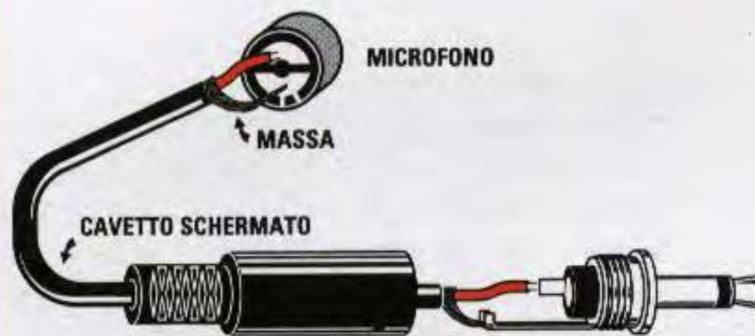
Fig.7 Per inviare il segnale microfonico sull'ingresso del trasmettitore dovete utilizzare uno spinotto jack maschio.
