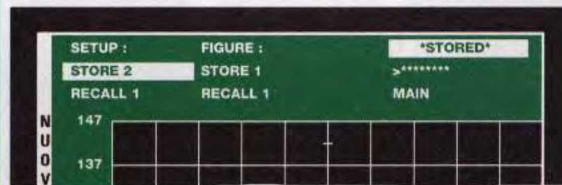
Fig.30 Pigiando Enter, in alto a destra apparirà la scritta *Stored*, poi il cursore si porterà sulla scritta Main.
