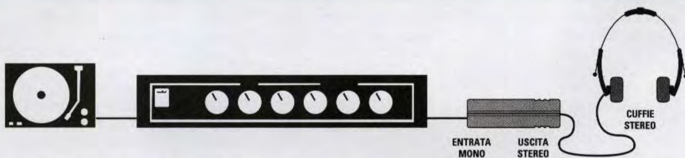
Fig.2 Il segnale da applicare sull'ingresso di questo convertitore Mono-Stereo va prelevato dall'uscita di un preamplificatore provvisto di controllo di Tono e di Volume.
