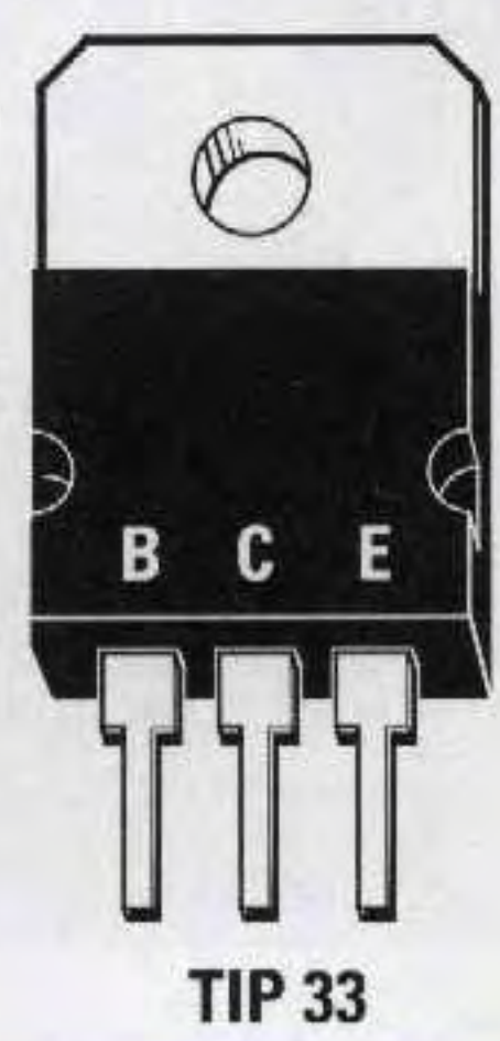
Fig.1 Schema elettrico e connessioni degli integrati e dei transistor.
