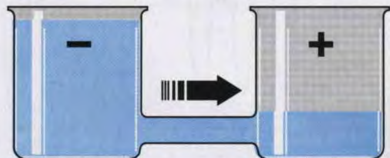
Fig.32 Un tubo grosso farà fluire molta acqua dal polo negativo verso il positivo.
