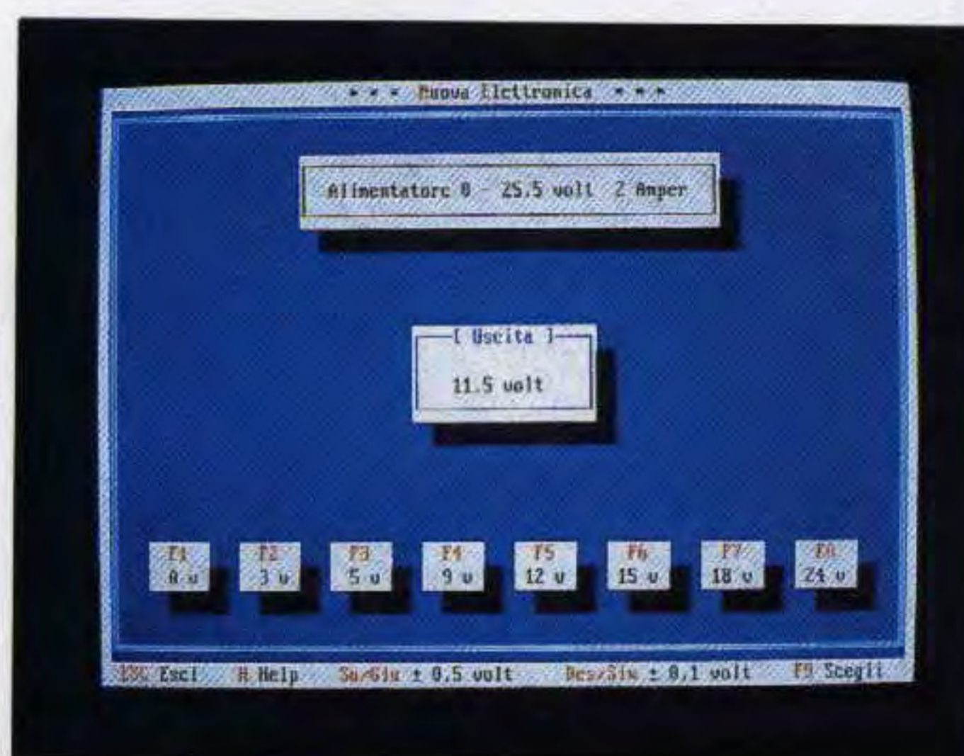
Fig.19 Se premete il tasto opposto, cioè quello della freccia Giù, la tensione diminuirà con passi di 0,5 volt.
