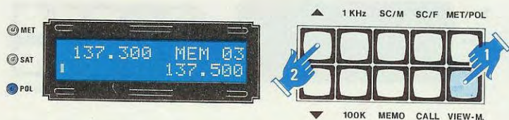
Fig. 58 Poi pigiare il tasto VIEW-M quindi i tasti P1-P2 fino a trovare la memoria con la frequenza desiderata.
