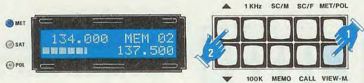
Fig.49 Per vedere quali frequenze sono memorizzate, dovrete pigiare il tasto VIEW-Memory poi i tasti P1 e P2.
