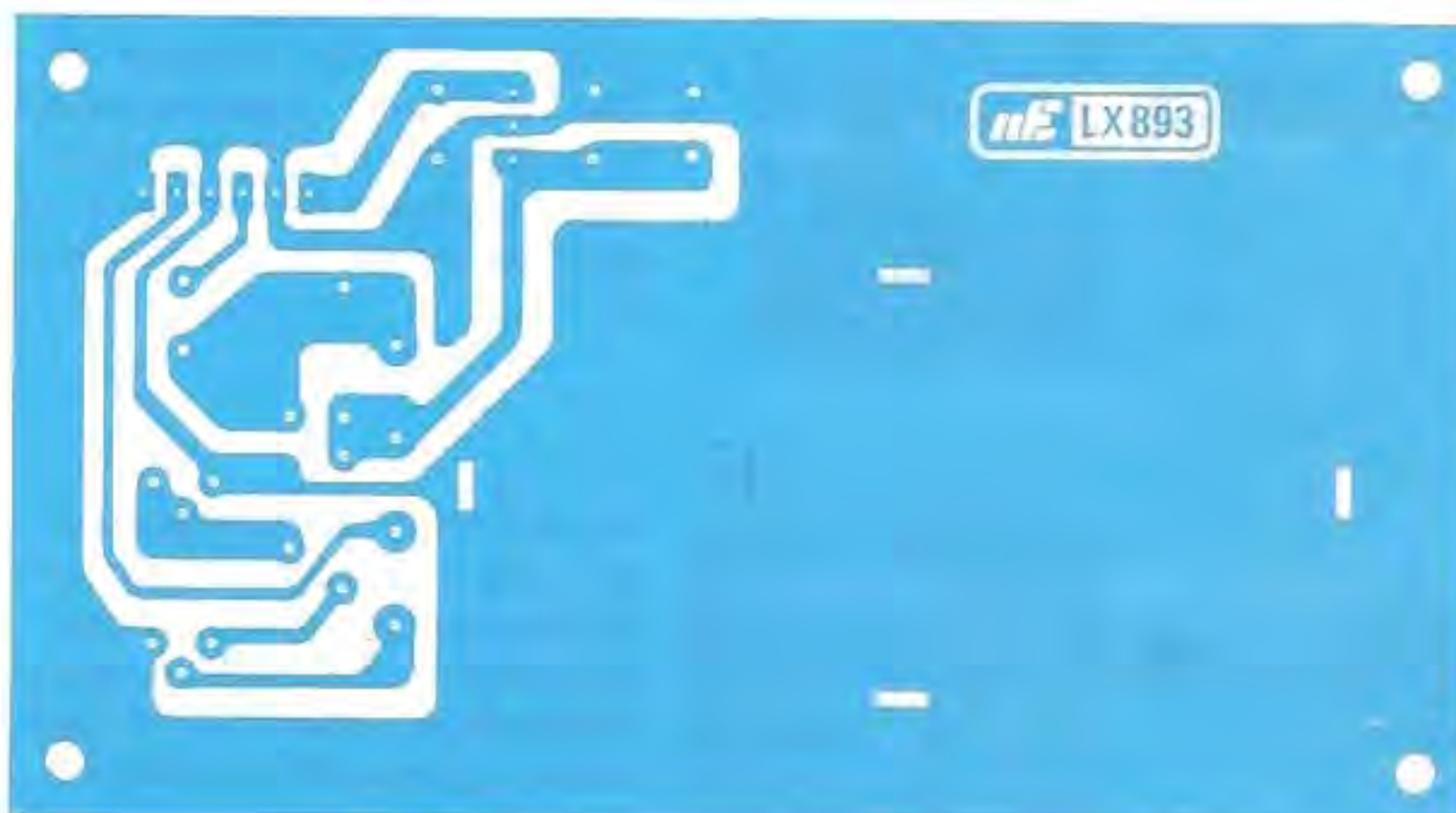
Fig.3 Disegno a grandezza naturale del circuito stampato LX.893. Si notino le asole per fissare le linguette del modulo.
