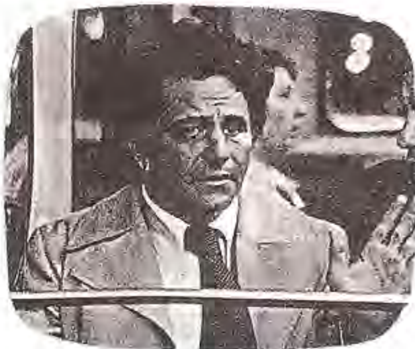
Fig.234 Se il segnale che giunge al televisore risultasse leggermente scarso, cioè sui 57 dBmicrovolt, ma con un rapporto Segnale/Rumore maggiore di 34 dB, l'immagine sul video risulterebbe perfetta.
