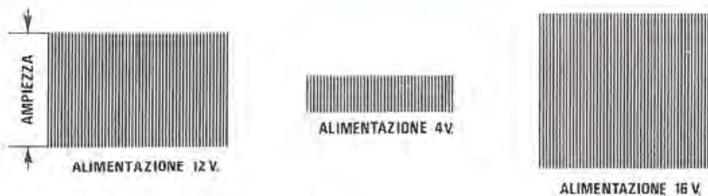
Fig.5 Se verificaste con un oscilloscopio l'ampiezza di un segnale di Alta Frequenza erogata da un trasmettitore, alimentato con una tensione di 12 volt, potreste ottenere un segnale come visibile a sinistra. Abbassando la tensione a 4 volt, l'ampiezza di tale segnale si ridurrà, mentre alzandola a 16 volt questa ampiezza aumenterà rispetto a quella dei 12 volt.
