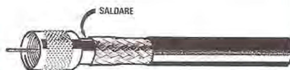
Fig.22 Il connettore da inserire nell'ingresso del gruppo UHF internamente è vuoto, in quanto serve solo da supporto per il cavo coassiale che giunge dal "Convertitore LNC".
