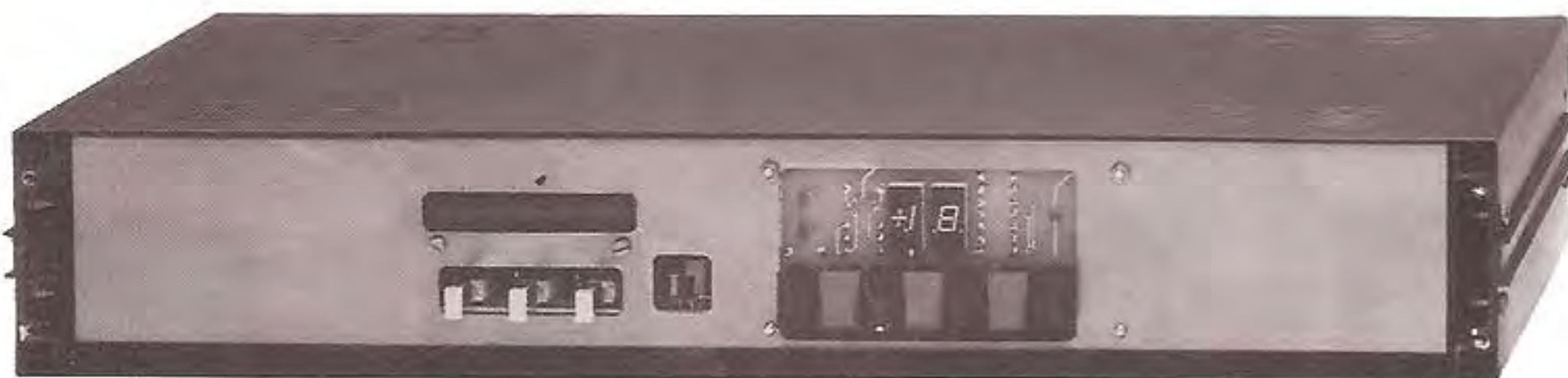
Fig.17 Sul contopannello frontale di tale mobile fisserete il circuito stampato della pulsantiera LX.891 e della barra a diodi led LX.891/B, utilizzando gli appositi distanziatori.
