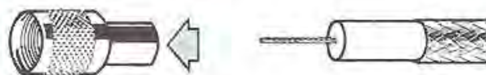
Fig.22 Il connettore da inserire nell'ingresso del gruppo UHF internamente è vuoto, in quanto serve solo da supporto per il cavo coassiale che giunge dal "Convertitore LNC".
