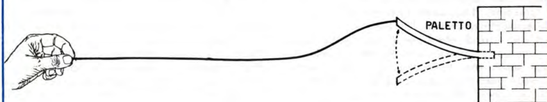
Fig. 4 Quando il « carico », cioè la struttura che sorregge la corda, è in grado di assorbire completamente le oscillazioni queste si trasferiscono dalla corda al carico senza che nascano ulteriori fenomeni perturbatorii. L'onda, cioè, attraversa la corda una volta sola: parte dalla nostra mano, compie velocemente il tragitto sino al carico e si dissipa totalmente su quest'ultimo.
