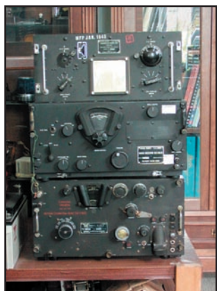
Un ensemble de Signal Corps BC 340, daté de 1945. Démonté d'un bombardier.
