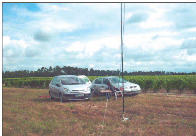
L'installation de l'antenne supportée par une canne à pêche.
