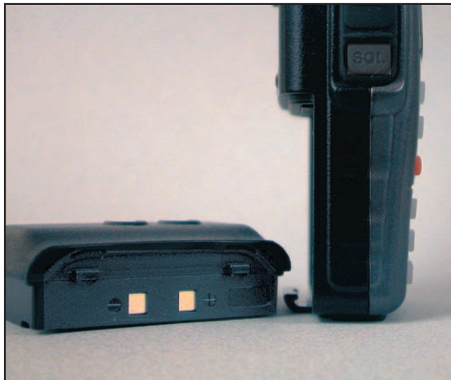
Profil de l'IC-E90: la batterie Li-Ion de 7,4 V est peu encombrante.
