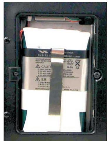
Installation de la batterie.
