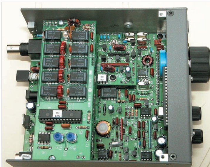
Les deux platines installées dans le K1.
